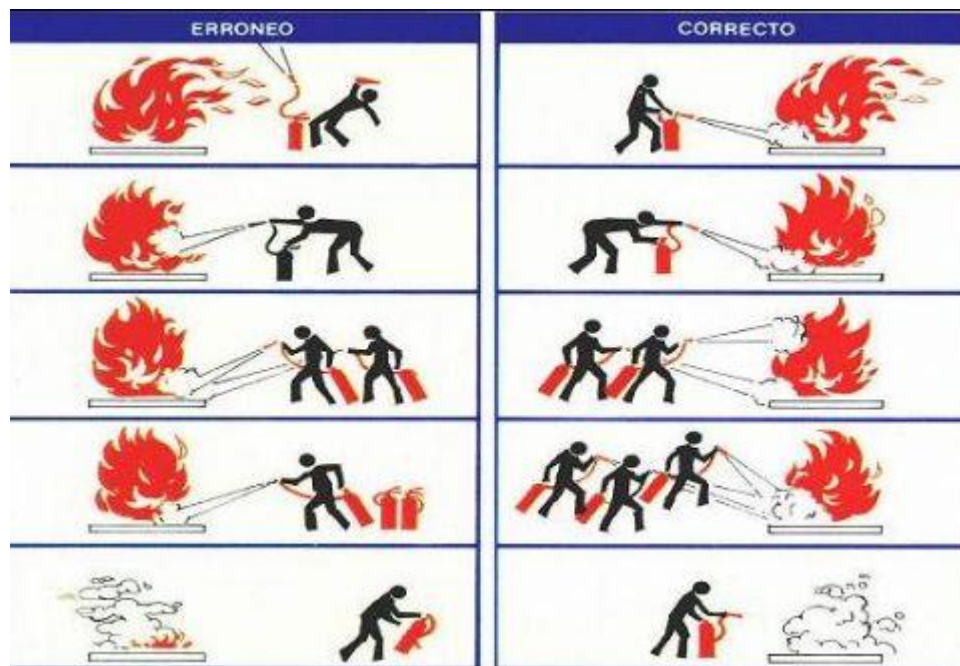
Figura 43. Correcto uso de extintores
