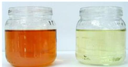
Figura 2.14 Descomposición del aceite dieléctrico.
