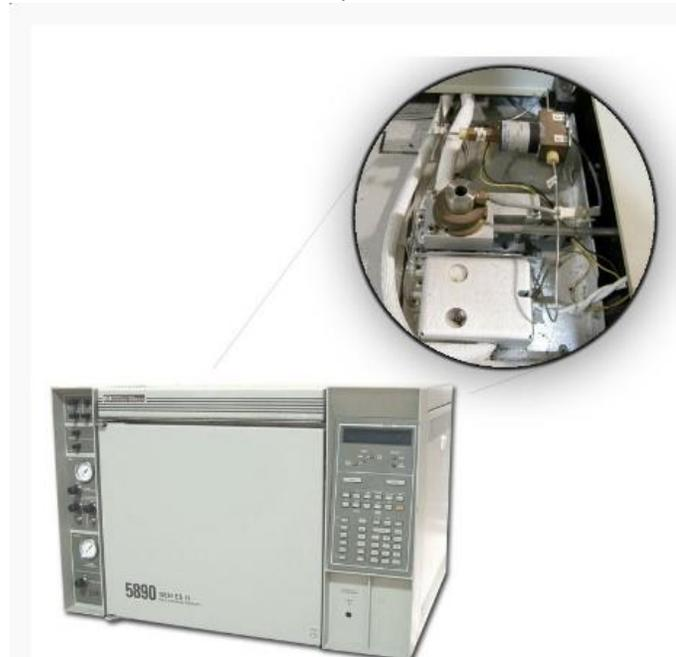
Figura A.7 Equipo HP 5890 Series II GC con FID y TCD
