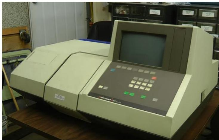
*Figura A.3 Un espectrómetro FTIR recoge simultáneamente datos de alta resolución espectral en un amplio intervalo espectral. Esto confiere una ventaja significativa sobre un dispersivo espectrómetro que mide la intensidad sobre una gama estrecha de longitudes de onda a la vez.*
