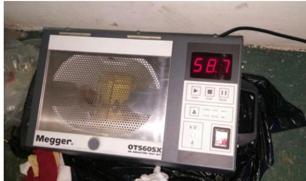
Figura A.6 Equipo utilizado para determinar la resistencia dieléctrica del líquido aislantes, tales como los aceites aislantes utilizados en transformadores y otros aparatos eléctricos. (Son transportables y adecuados para uso en laboratorio, así como pruebas en el sitio).
