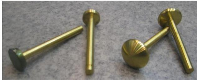
Figura 5.1 Muestra a la izquierda los electrodos cara plana utilizados para la norma astm D-877 y por el lado de la derecha muestra los electrodos cara esférica para la norma astm D-1816.
