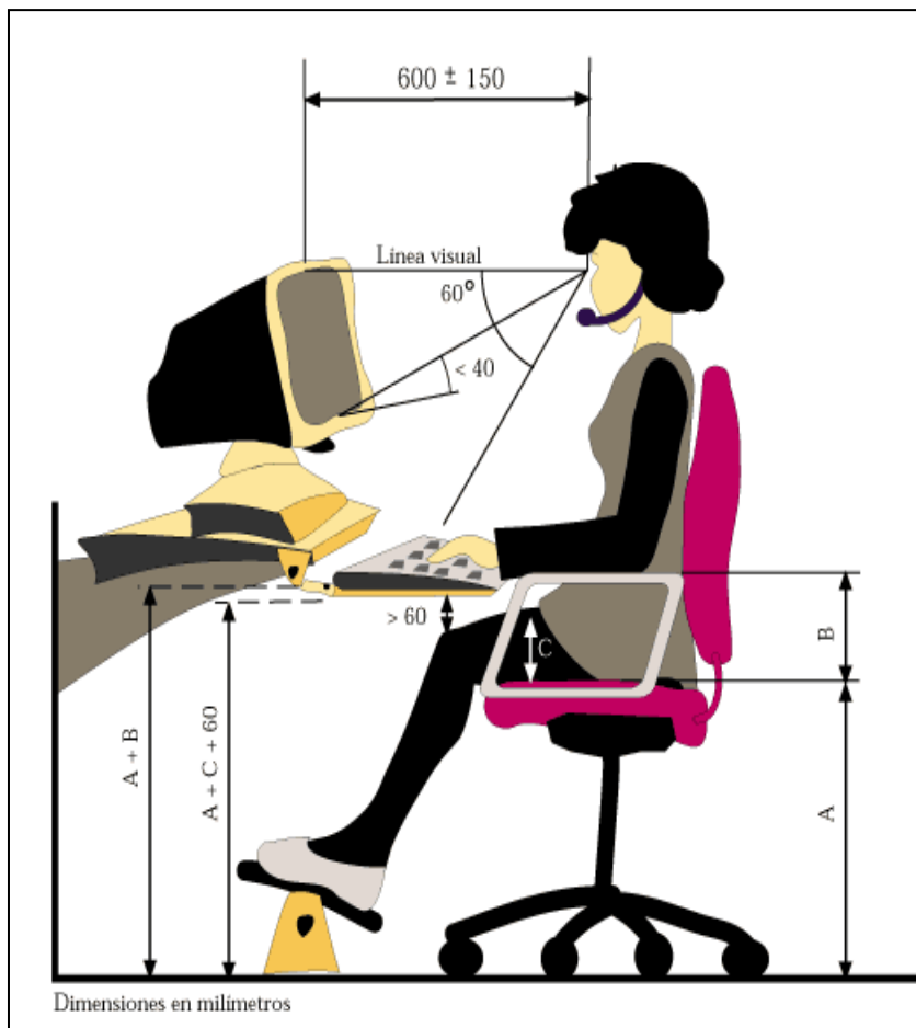
Figura 4 Dimensiones en milímetros de los parámetros ideales en un puesto de trabajo de computación.
