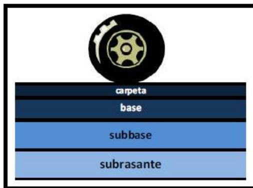
**Figura 2.1** Esquema típico del paquete estructural de un pavimento flexible.
