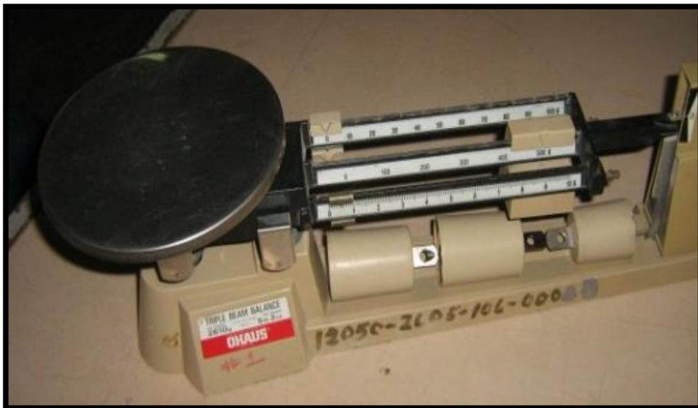
**Figura 3.15** Balanza de 0.1 gr. de precisión.
