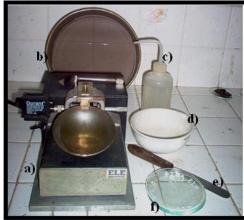
**Figura 3.14** Equipo utilizado en el ensayo de límites.
