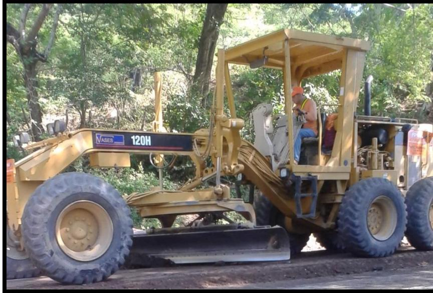
**Figura 5.13** Uso de una motoniveladora para conformar la superficie.
