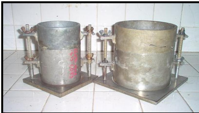
**Figura 3.17** Moldes para ensayos de compactación.
