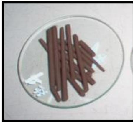
**Figura 3.13** Porciones del suelo obtenidas en ensayo de límites.
