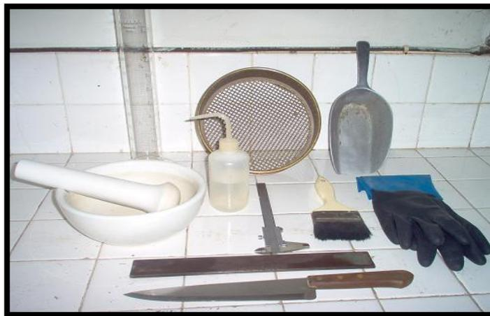
**Figura 3.18** Equipo utilizado para el ensayo de compactación.
