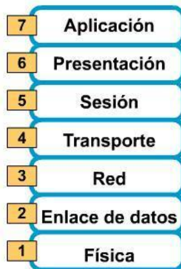
Fig. 2.1-B: Capas del modelo OSI
