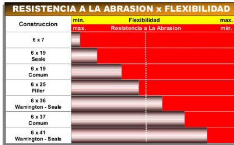
Fig. 2.7. El cable 6x41 es el más flexible, gracias al menor diámetro de sus alambres externos, además es el menos resistente a la abrasión en cuanto que lo contrario ocurre con el cable de 6x7
