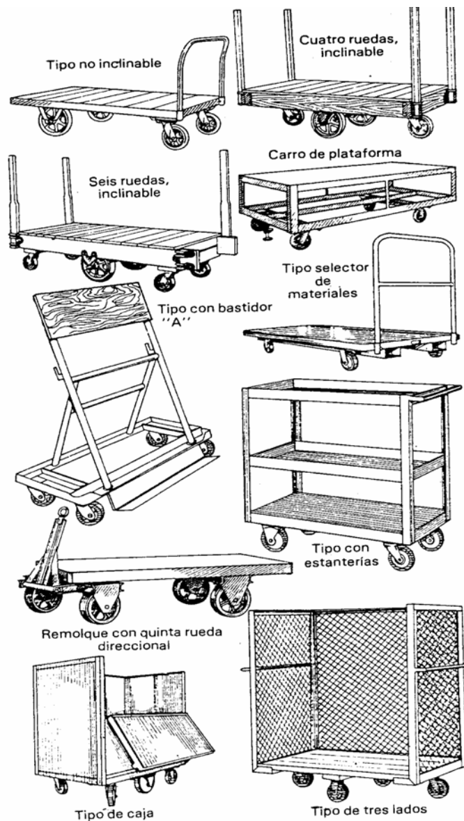
Figura 1.24. Carros para fábrica y colocación de las ruedas.
