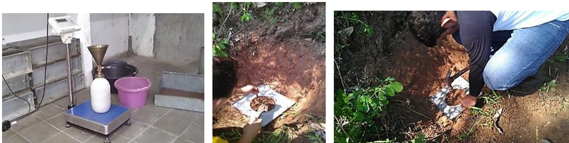
Ilustración 26- Realización de la prueba de densidad de campo
