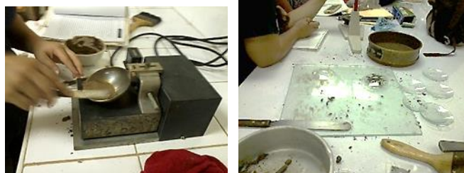
Ilustración 29- Determinación de límite líquido, límite plástico e índice de plasticidad.
