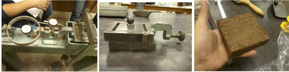
Ilustración 30- Realización del ensayo corte directo.
