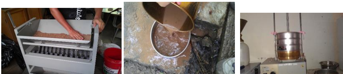
Ilustración 28- Realización del ensayo análisis granulométrico método combinado.
