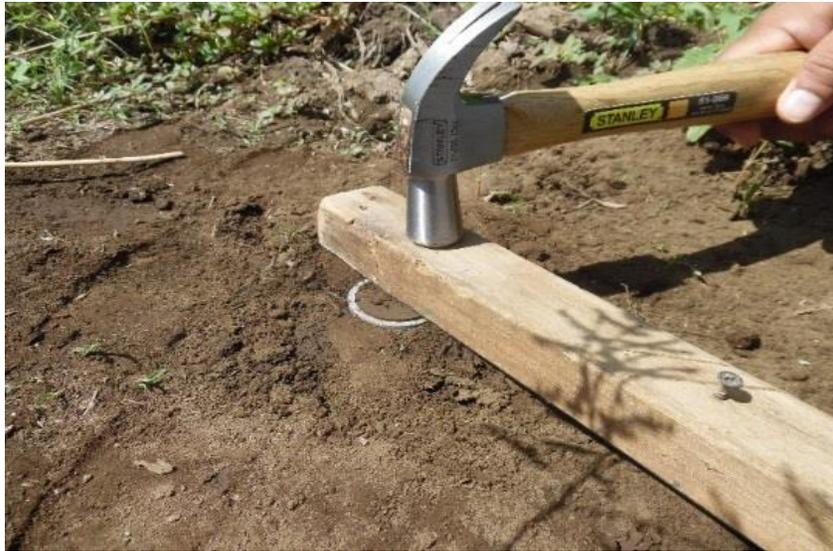
Figura 3. Toma de muestras por el método del cilindro de volumen conocido
