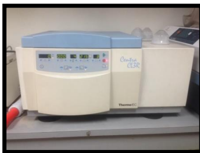
Figura A- 18 Centrífuga refrigerada marca Thermo® IEC Centra CL3R.
