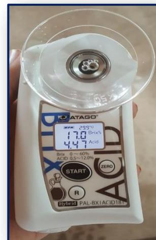
Figura 11. Medición de grados Brix y acidez en lixiviado con el refractómetro PAL-BX ACID181
