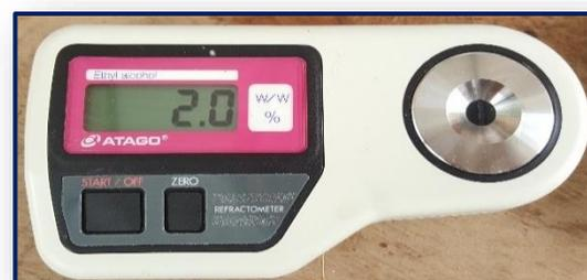
Figura 12. Medición de porcentaje de alcohol con refractómetro PET - 109 en cotiledón
