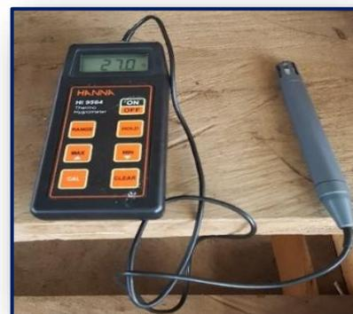
Figura 8. Termohigrómetro HANNA HI 9564, para la medición de humedad relativa y temperatura
