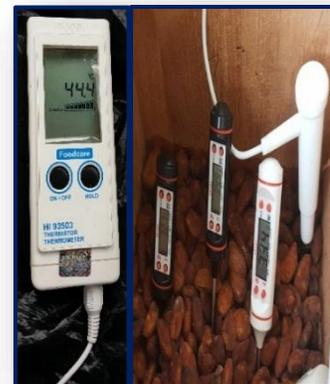
Figura 9. Medición de temperatura masa de cacao con termómetros HANNA HI 93503 y DIGIFLEX TP101
