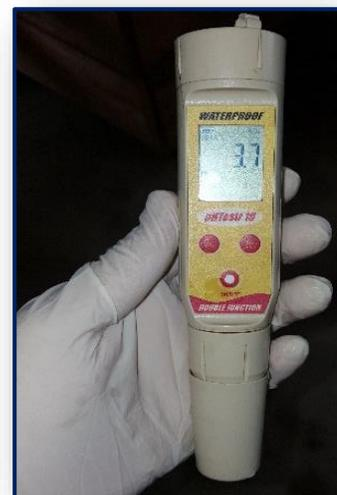
Figura 10. Uso del pH-metro digital OAKTON pHTestr 10 en la medición de testa
