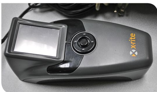
**Figura 57.** Densitómetro, es utilizado por profesionales en impresión para determinar si la saturación de los colores satisfacen los requerimientos del producto final.
