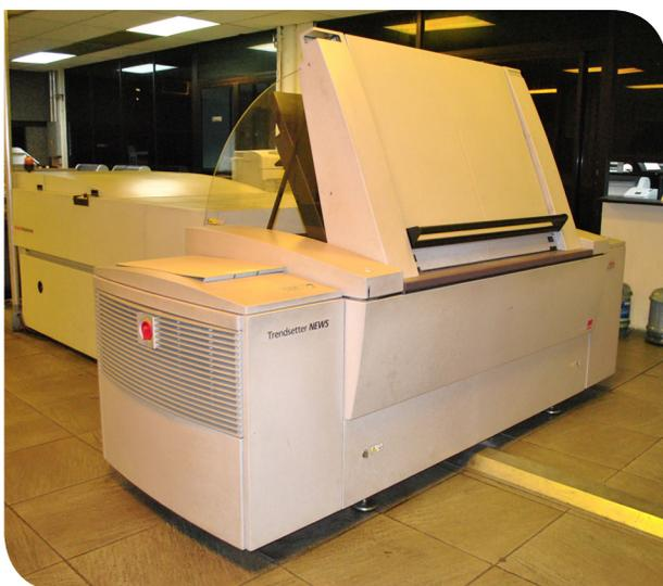
Esta técnica está basada en un sistema de filmación directa a través de un rayo láser que genera la imagen deseada sobre la plancha.
