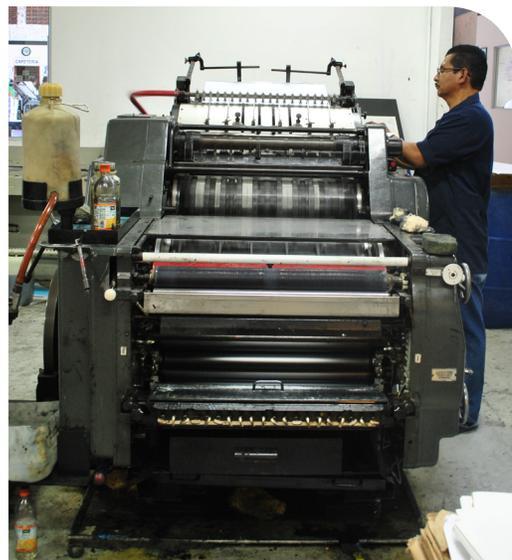
Máquina Offset *Hamada 600* : Imprime doble carta 8.5 x 11, 11x 17.5 pulgada, utiliza plancha CTP de 11x18 pulgadas y plancha poliéster (Omega), los tipos de impresos que realiza son: facturas, recibos, tarjetas de presentación, carnet, viñetas, hojas volantes, etc.
