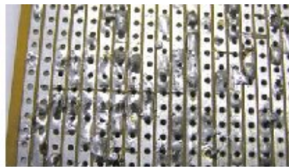
Figura 4.2.2—6 Detalle de soldaduras y cortes en una placa de tiras usada varias veces
