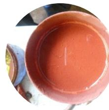
**Humectación:** Se deposita el polvillo en un recipiente con agua y se mezcla hasta formar un barbotina uniforme.
