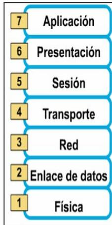
Figura 2. 14 División en capas del Modelo OSI.
