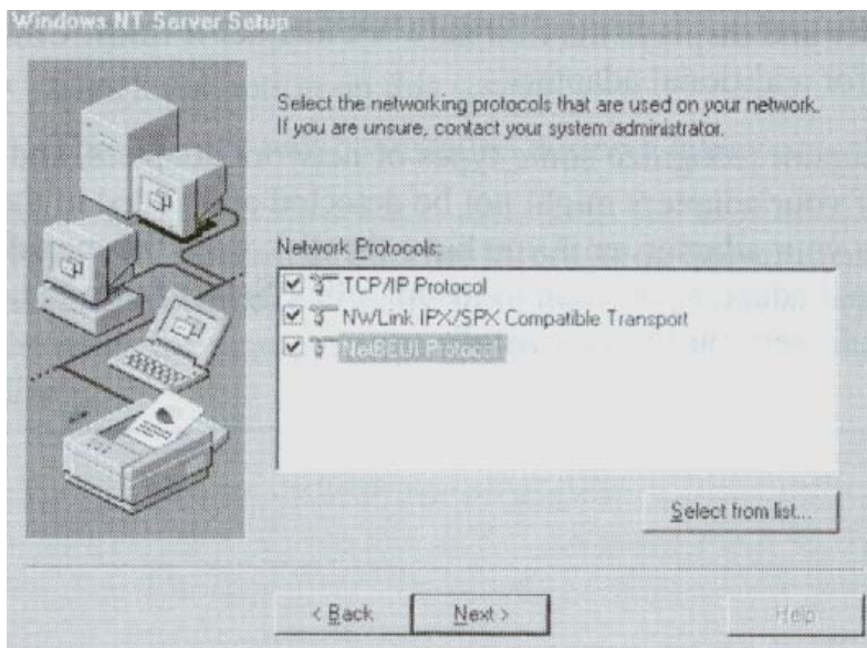
Figura 4.11 Pantalla para seleccionar protocolos en la instalación.
