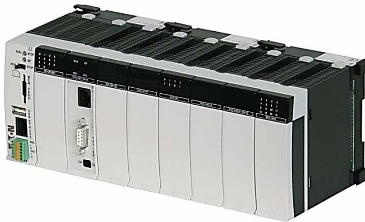
Figura 1.36 PLC tipo modular [17]
