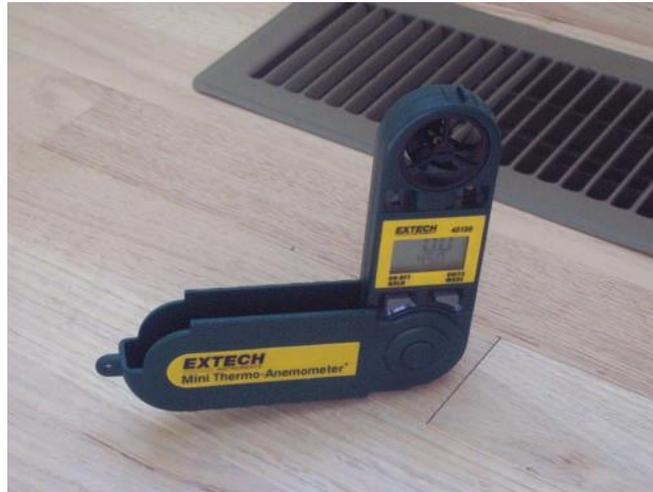
**Figura 32.** Anemómetro de aspas giratorias. [32]
