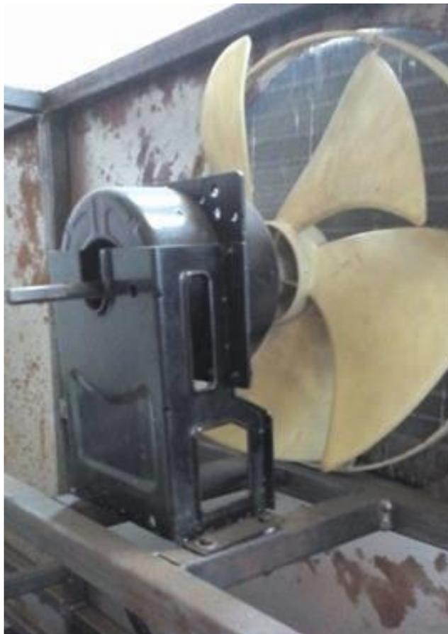
**Figura 53.** Ventilador del condensador.
