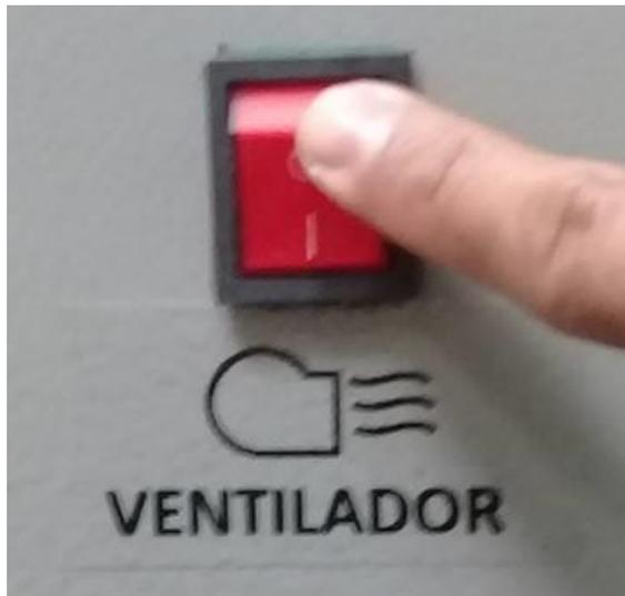
**Figura 105.** Encendido del ventilador centrífugo.
