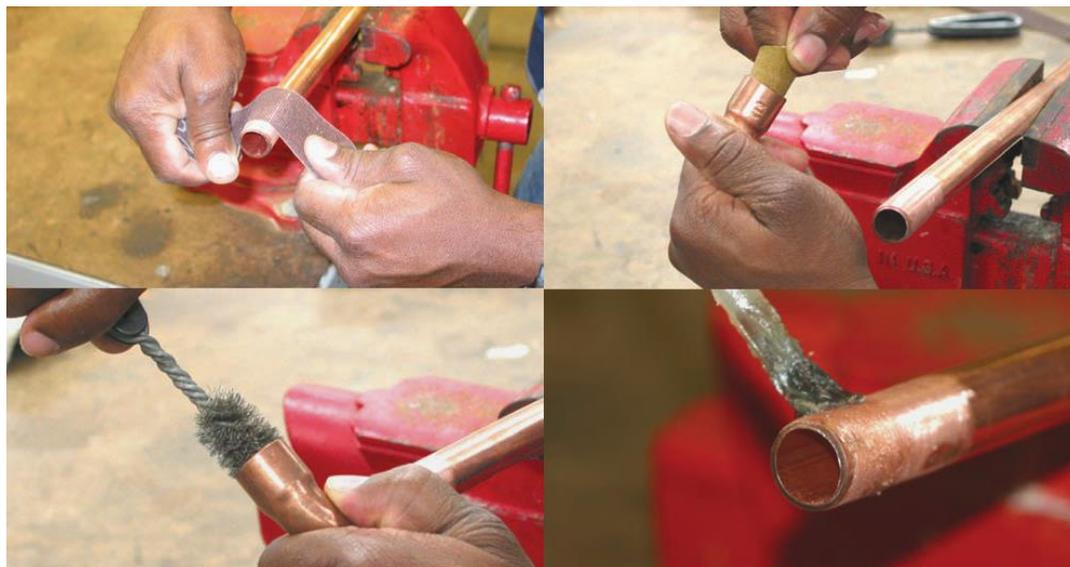
**Figura 67.** Limpieza y aplicación de fundente sobre el tubo a soldar.
