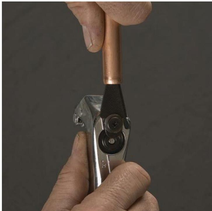
**Figura 61.** Forma correcta de utilizar escariador.
