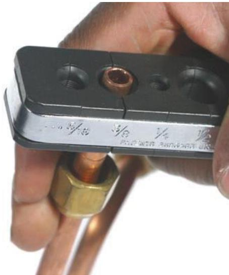
**Figura 62.** Sujeción de tubería antes de abocardar.
