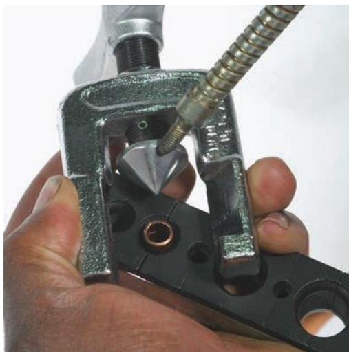
**Figura 63.** Ejemplo de cuánto debe salir tubo antes de abocardar.
