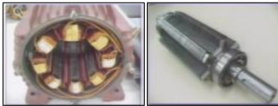
Figura 8. Estator y rotor de la tecnología de los motores con reluctancia conmutada. 7
