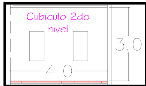
Figura 7.36 Cubículo de trabajo con medidas y luminarias
