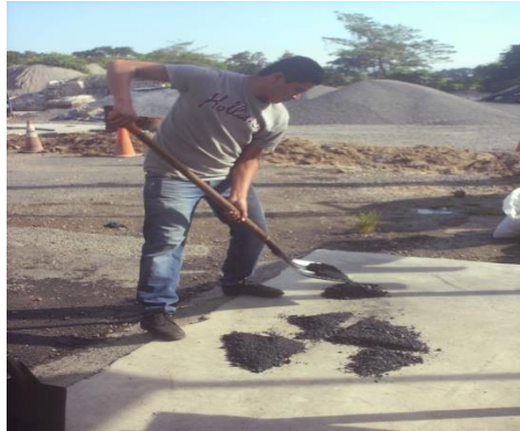
FIGURA 3.17 Cuarteo de la mezcla asfáltica: Procedimiento de Cuarteo, Fracciones resultantes al final del cuarteo.
