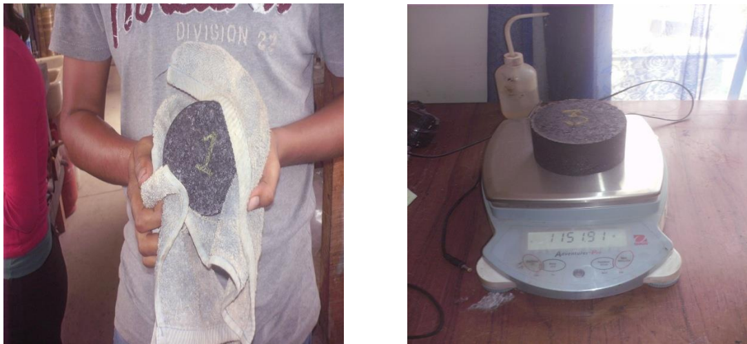
FIGURA 3.24 Peso superficialmente seco de cada Briqueta Fuente: Presentación de los autores, Laboratorio Planta Asfáltica, Plantel, Quezaltepeque, Constructora DISA, La Libertad
