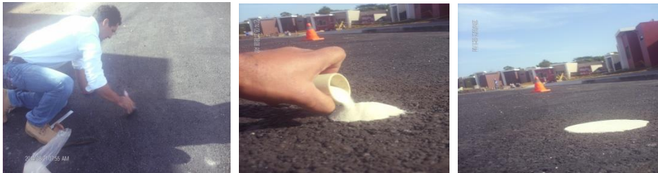
Figura 4.19 Proceso de toma de lecturas por medio del método del círculo de arena Fuente: Presentación de los autores.
