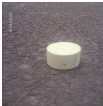
Figura 4.12 Recipiente Cilíndrico para ensayo de la mancha de arena Fuente: Presentación de los autores
