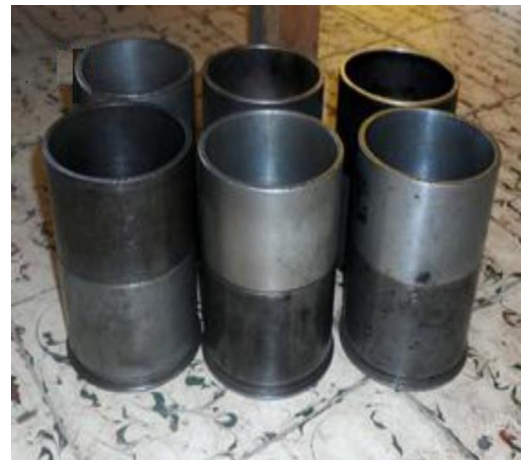
FIGURA 3.18 Calentado de equipo de compactación: Calentamiento en cocina de martillo de compactación y espátulas, Moldes de compactación previo a calentamiento en horno.
