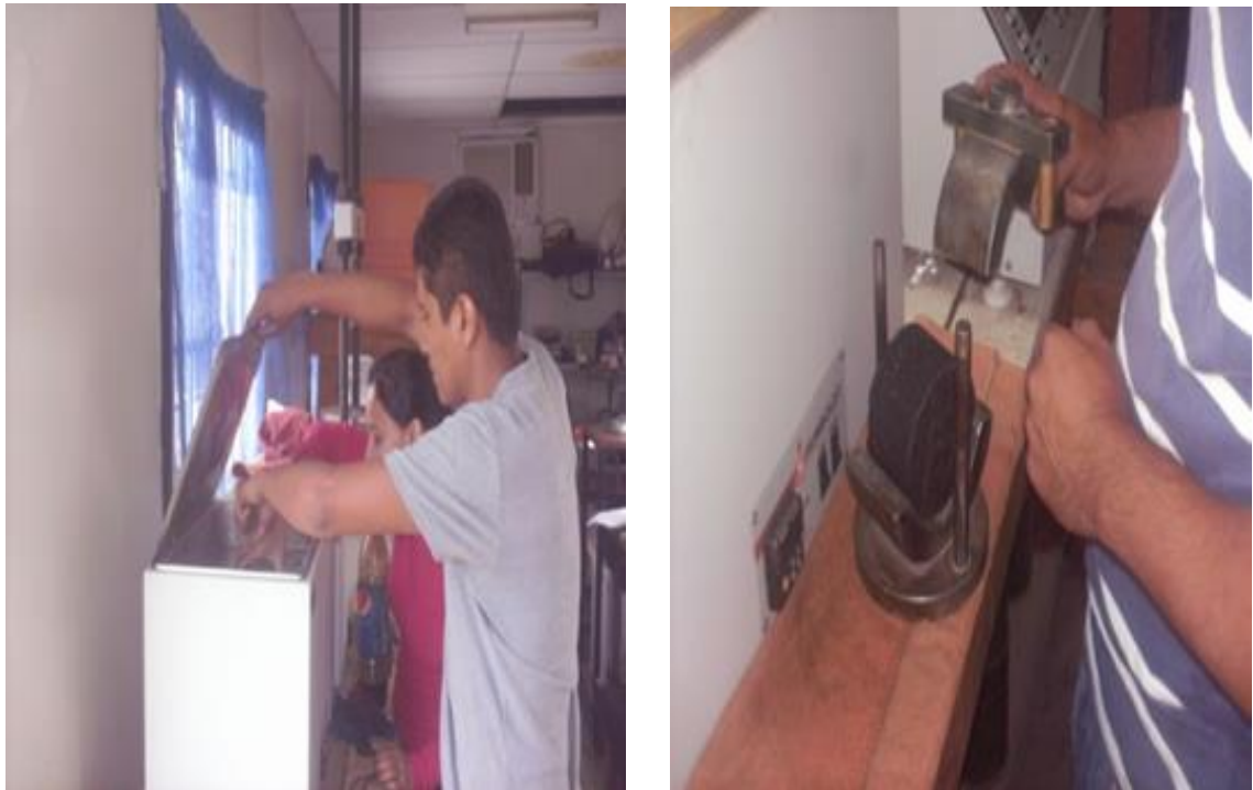
FIGURA 3.28 Colocación de briqueta antes de ensayo: Sacar las briquetas del baño de maría-Colocación en maquina de ensayo de ensamble briqueta + quijada. Fuente: Presentación de los autores, Laboratorio Planta Asfáltica, Plantel, Quezaltepeque.
