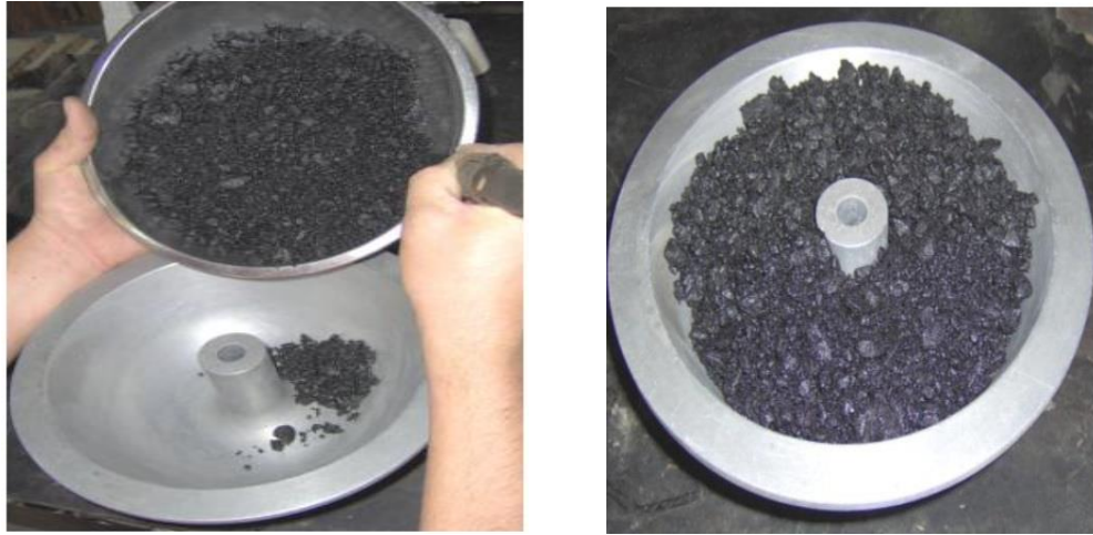
Figura 3.36 Mezcla siendo vertida en el tazón, Mezcla en el tazón Fuente: Presentación de los autores Laboratorio Planta Asfáltica, Plantel, Quezaltepeque, Constructora DISA, La Libertad
