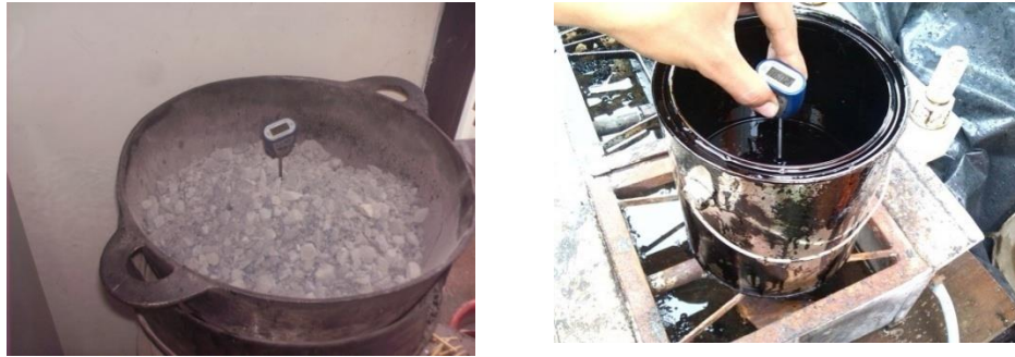
FIGURA 3.14 – Calentamiento previo de agregados y asfalto Chequeo de temperaturas para mezclado Fuente: Presentación de los autores, Laboratorio Planta Asfáltica, Plantel, Quezaltepeque, Constructora DISA, La Libertad
