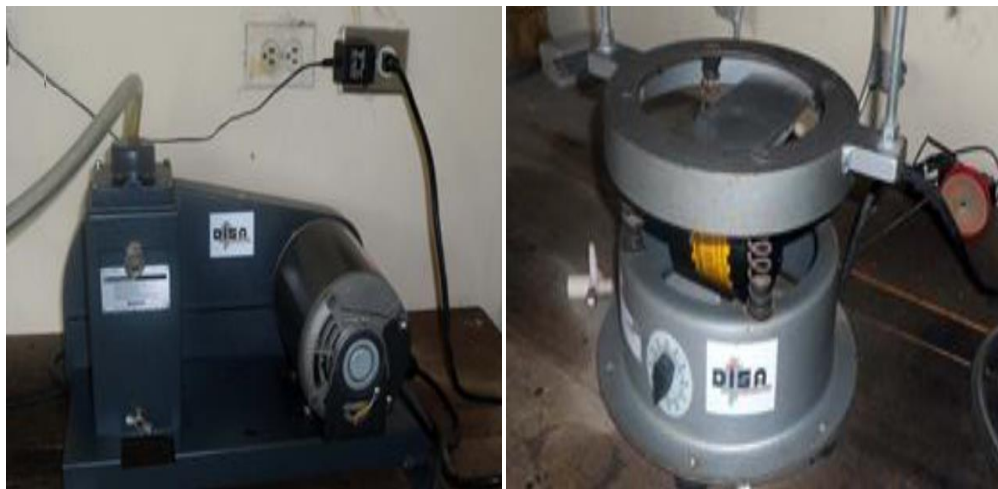
FIGURA 3.26 Equipo teórica máxima: Equipo para generar vacío Agitador Mecánico
