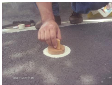
Figura 4.15 Colocación del material en la superficie del pavimento y generación de la mancha de arena, Fuente: Presentación de los autores.
