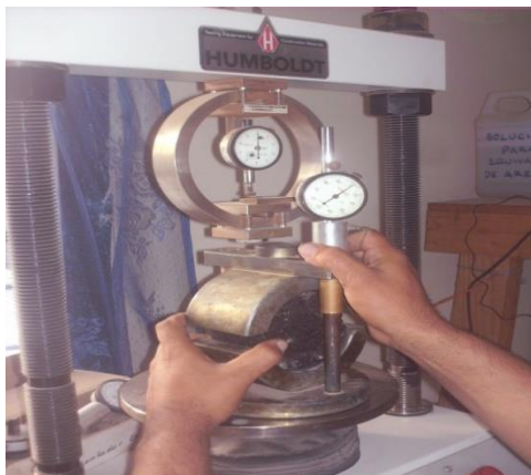
FIGURA 3.29 Colocación de briqueta antes de ensayo: Colocación del medidor de flujo- Aplicación de la carga a las briquetas Fuente: Presentación de los autores, Laboratorio Planta Asfáltica, Plantel, Quezaltepeque, Constructora DISA, La Libertad.
