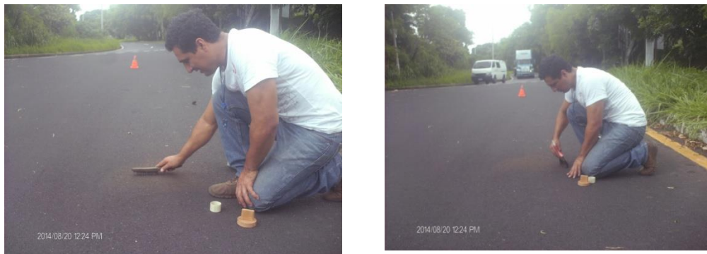
Figura 4.13 Selección, Inspección y Limpieza de tramo a estudiar Fuente: Presentación de los autores
