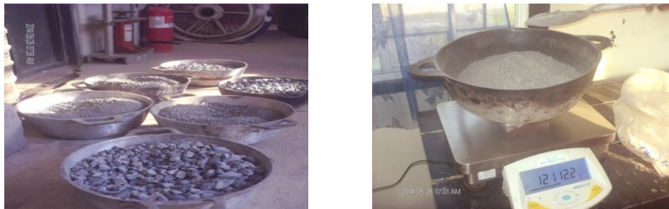
FIGURA 3.13 Material seco y pesado de cada una de las proporciones de agregado que se utilizaran en la elaboración de la mezcla.
