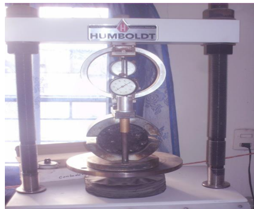
FIGURA 3.29 Colocación de briqueta antes de ensayo: Colocación del medidor de flujo- Aplicación de la carga a las briquetas Fuente: Presentación de los autores, Laboratorio Planta Asfáltica, Plantel, Quezaltepeque, Constructora DISA, La Libertad.
