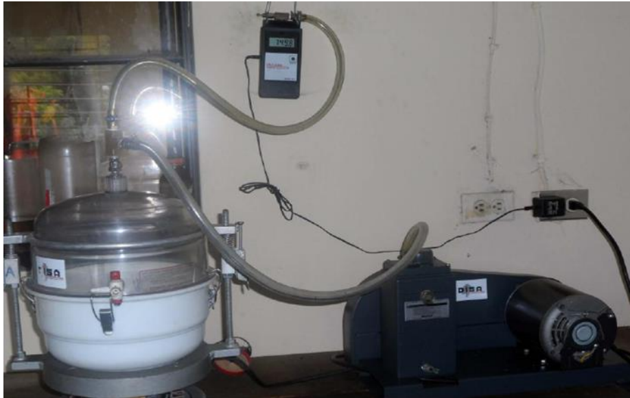
FIGURA 3.27 Equipo de vacío, vibrado, picnómetro y manómetro ensamblado. Fuente: Presentación de los autores, Laboratorio Planta Asfáltica, Plantel, Quezaltepeque, Constructora DISA, La Libertad
