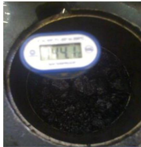
FIGURA 3.20 Verificación de temperatura de compactación, Chequeo de temperatura previo a compactar, Momento que la temperatura llega al valor esperado.
