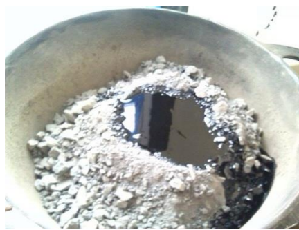
FIGURA 3.16 Mezclado de agregado y asfalto, Mezcla asfáltica elaborada Fuente: Presentación de los autores, Laboratorio Planta Asfáltica, Plantel, Quezaltepeque, Constructora DISA, La Libertad
