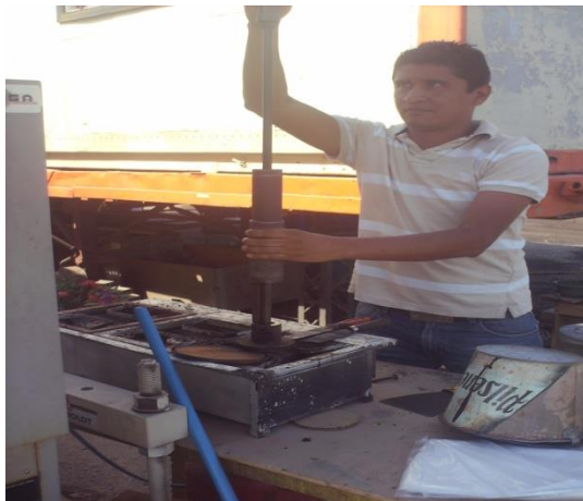
FIGURA 3.18 Calentado de equipo de compactación: Calentamiento en cocina de martillo de compactación y espátulas, Moldes de compactación previo a calentamiento en horno.
