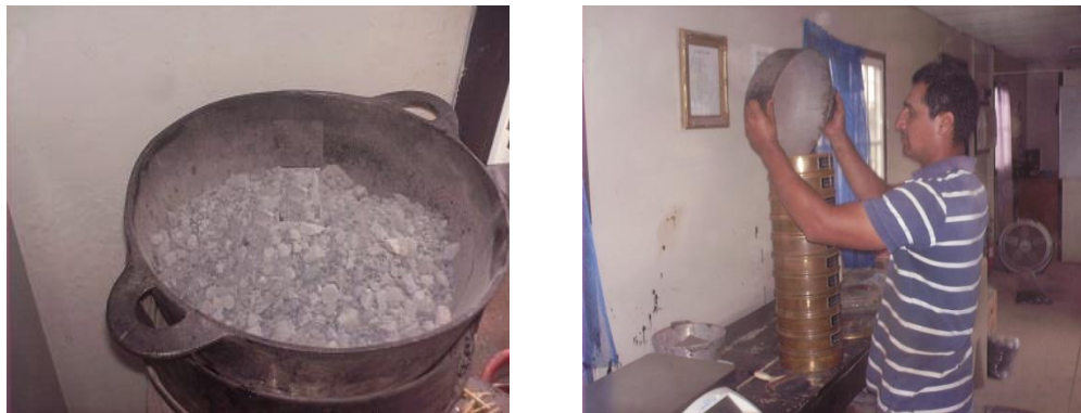
Figura 3.39 Calentamiento de agregado extraído y colocado en agitador mecánico para ensayo de granulometría
