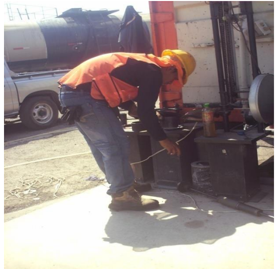
FIGURA 3.19 Colocación de la mezcla en el molde de compactación y compactación manual de la mezcla.
