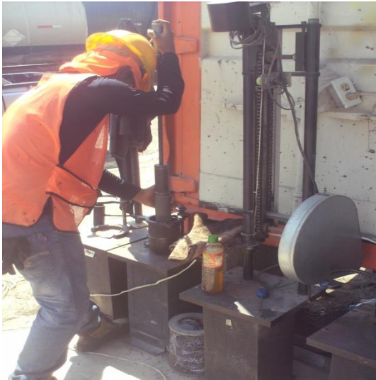
FIGURA 3.19 Colocación de la mezcla en el molde de compactación y compactación manual de la mezcla.
