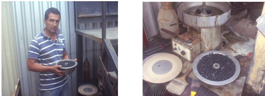
Figura 3.38 Mezcla siendo vertida en el tazón, Mezcla en el tazón Fuente: Presentación de los autores, Laboratorio Planta Asfáltica, Plantel, Quezaltepeque, Constructora DISA, La Libertad
