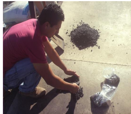
FIGURA 3.17 Cuarteo de la mezcla asfáltica: Procedimiento de Cuarteo, Fracciones resultantes al final del cuarteo.
