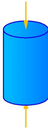
Figura 2.19 Muestra cilíndrica de concreto para ensayos de compresión estándar
