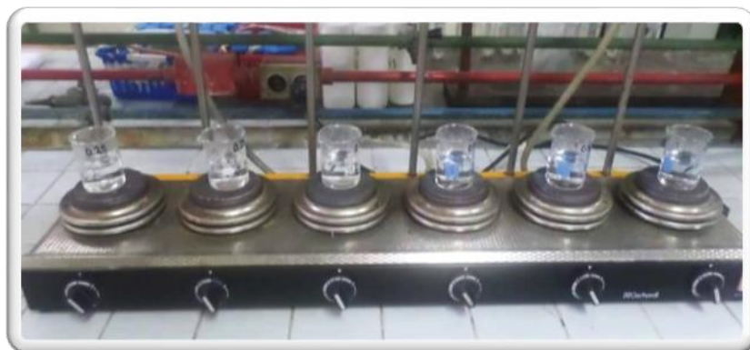
c. Las muestras tratadas se ponen a ebulir por 10 minutos y después se dejan enfriar
