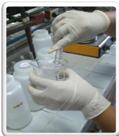
a. Se miden 50 ml de agua filtrada con balón y se ponen en beaker
