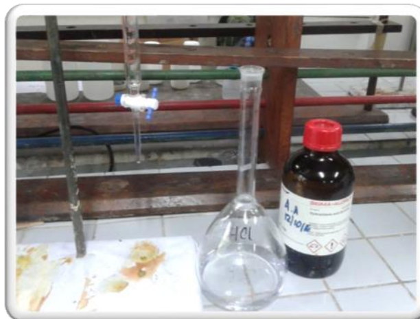
b. Se agrega 2.5 ml de HCl concentrado con bureta
