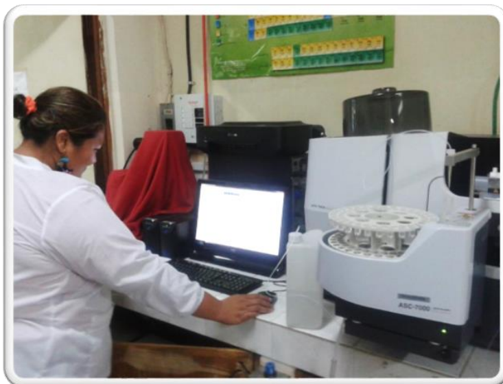
a. Análisis de las muestras de aguas tratadas por espectrofotometría de absorción atómica
