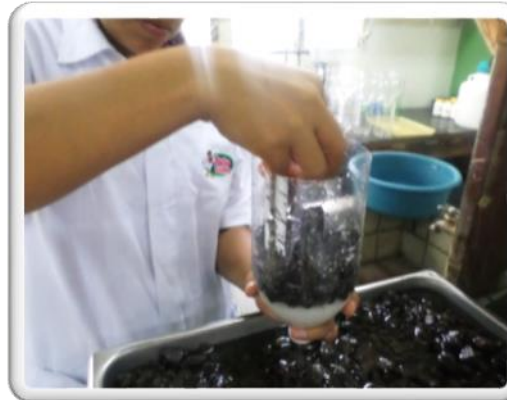
d. Colocación de capa de grava
