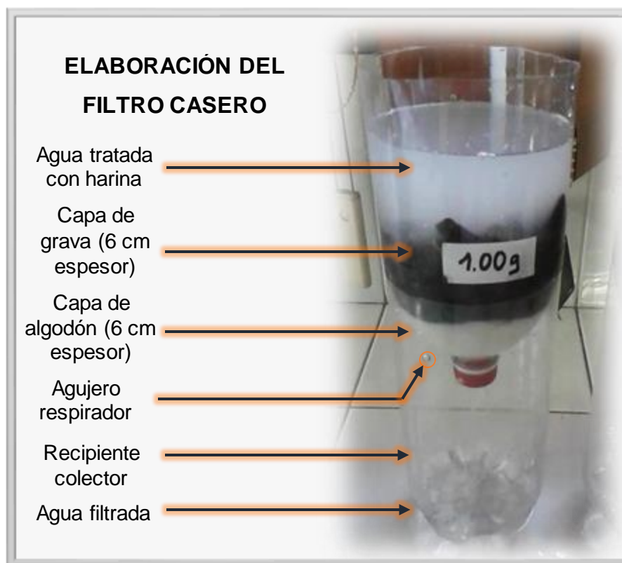
Figura 1. Construcción del filtro casero
