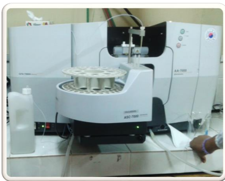
b. Espectrofotómetro de absorción atómica (modelo AA-7000, marca Shimadzu)
