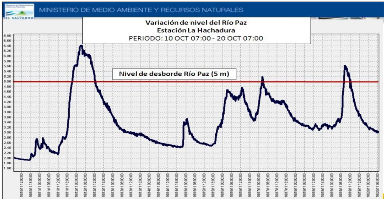
Figura No. 3.8: Nivel de desbordamiento DT-12E Estación La Hachadura Fuente: MARN, Cuenca Baja del Río Paz y zonas inundables, Febrero 2012.
