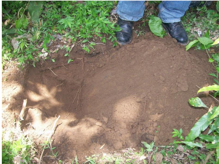
Figura No. 4.15: Excavación para extracción de muestras de suelo
