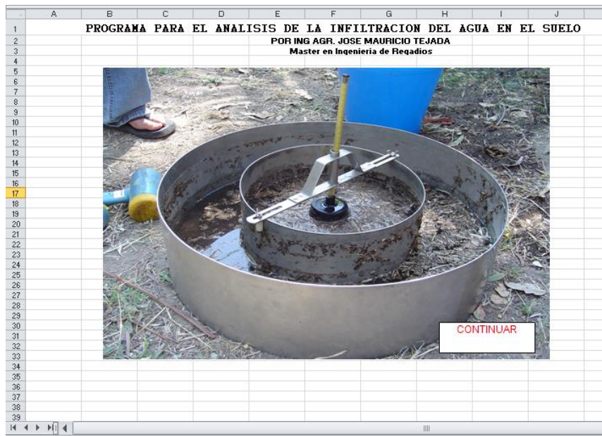
Figura No. 4.3: Portada de la hoja de Cálculo para determinar la Infiltración del agua en el suelo.
