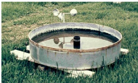
Figura No. 2.8 Tanque Evaporímetro Clase A
