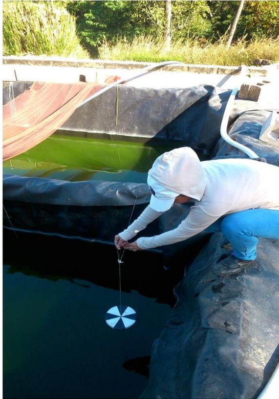
**Figura A-7.** Disco secchi.
