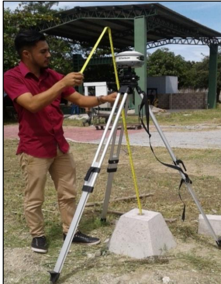
Figura 5.16: Medición de altura inclinada de antena.
