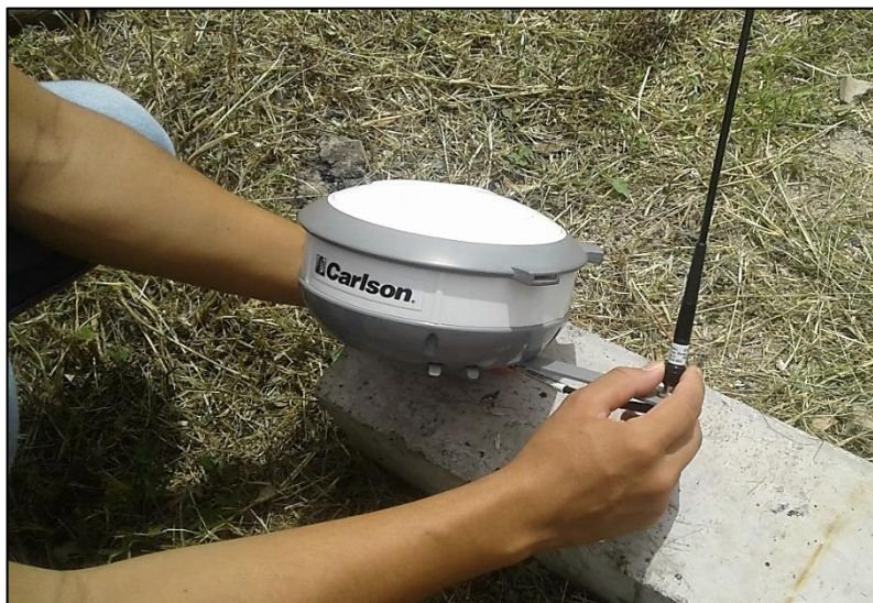
Figura 5.23: Colocación de antena.
