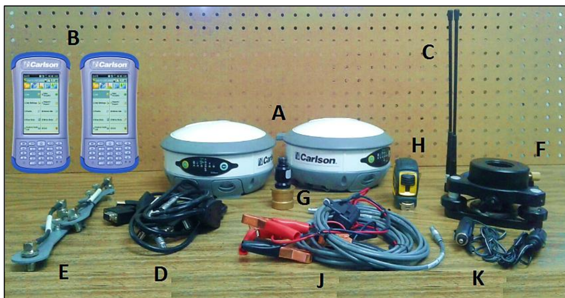
Figura 5.8: Elementos necesarios para la medición con equipo GPS diferencial.
