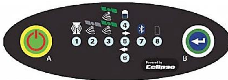
Figura 5.9: Conjunto de botones y luces LED del receptor GPS
