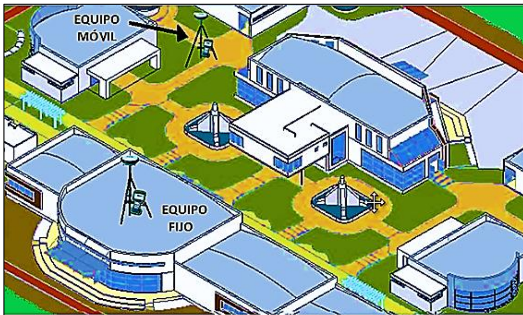
Figura 5.7: Ubicación recomendada para receptor Base y Móvil en técnica RTK.
