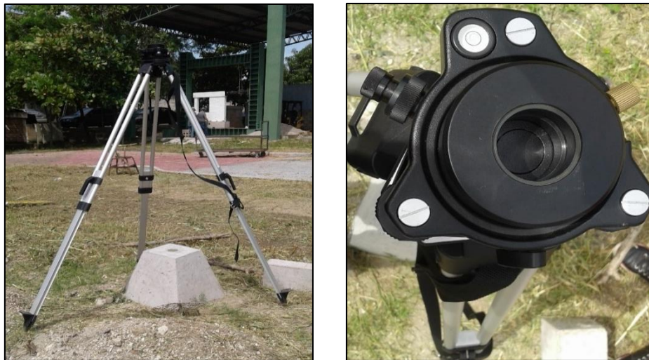
Figura 5.14: Colocación de trípode con base nivelante.
