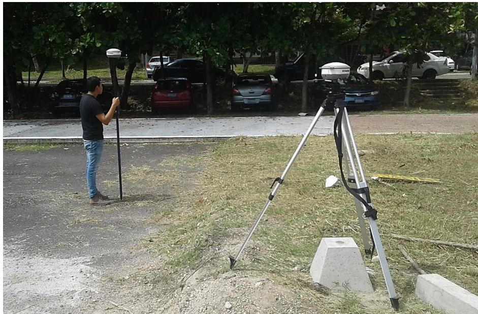
Figura 5.24: configuración del receptor móvil en trabajos que no requieran alta precisión.
