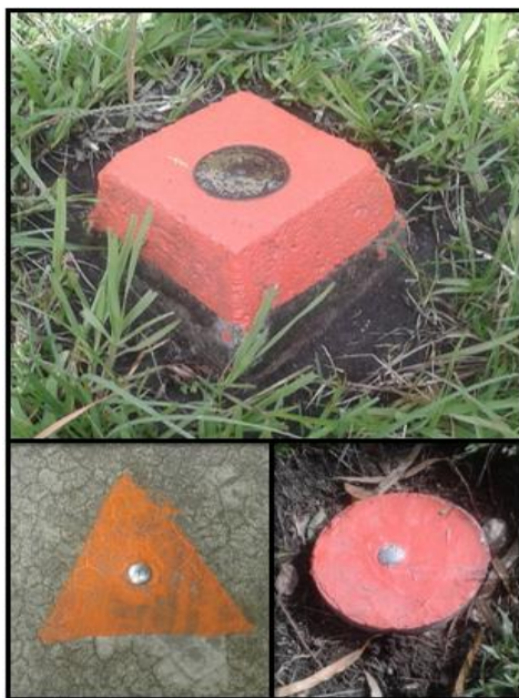
Figura 6.7: Tipos de mojoneros que conforman poligonal FIAUES
