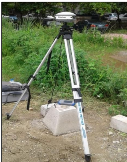
Figura 5.17: Colector y receptor conectados a través de cable.
