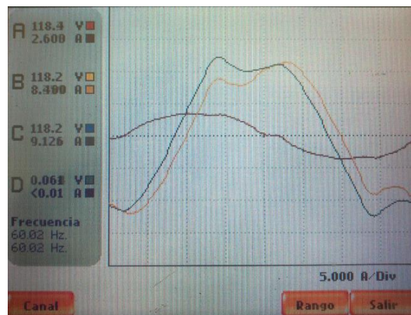
Ilustración 66. Gráficas de corriente carga inductiva a una irradiancia de 522.2 W/m 2
