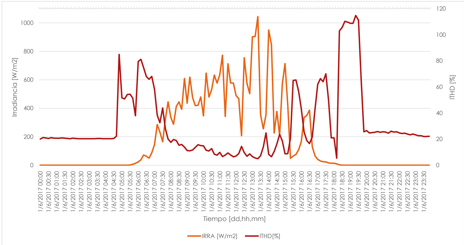
Ilustración 25. Irradiancia e ITHD vs tiempo (SB 700U)
