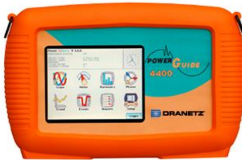
Ilustración 22. Dranetz Power Guide 4400
