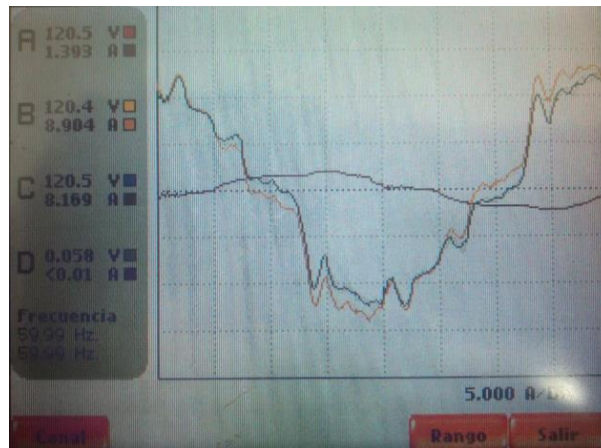
Ilustración 62. Gráficas de corriente carga capacitiva a una irradiancia de 241.0W/m 2
