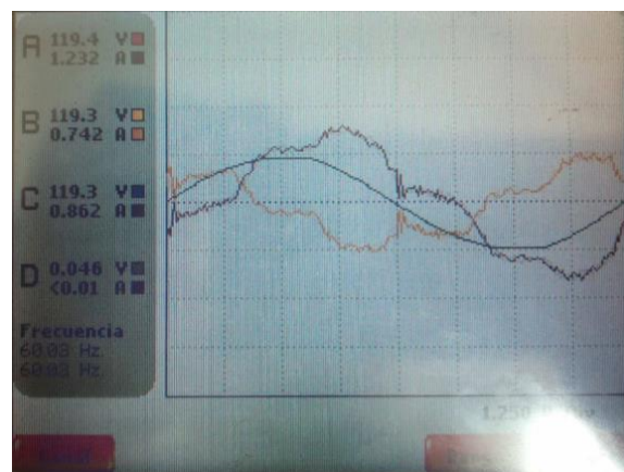
Ilustración 59. Gráficas de corriente carga resistiva a una irradiancia de 218.5W/m 2
