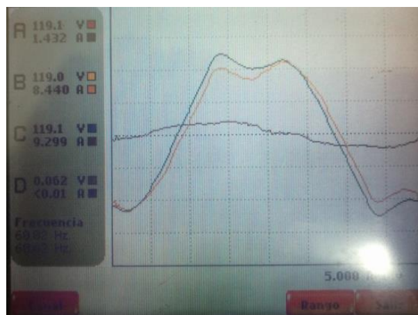
Ilustración 65. Gráficas de corriente carga inductiva a una irradiancia de 254.7W/m 2
