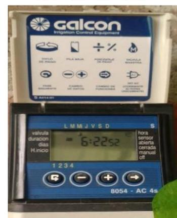
**Automatización:** Para utilizar el riego por goteo correctamente, hay que hacer riegos con mucha frecuencia. Para no tener que desplazarnos hasta el cultivo, existen en el mercado pequeños programadores de riego que funcionan con pilas, el cual se programa para queda 4:00 minutos durante el día y el automáticamente se active.
