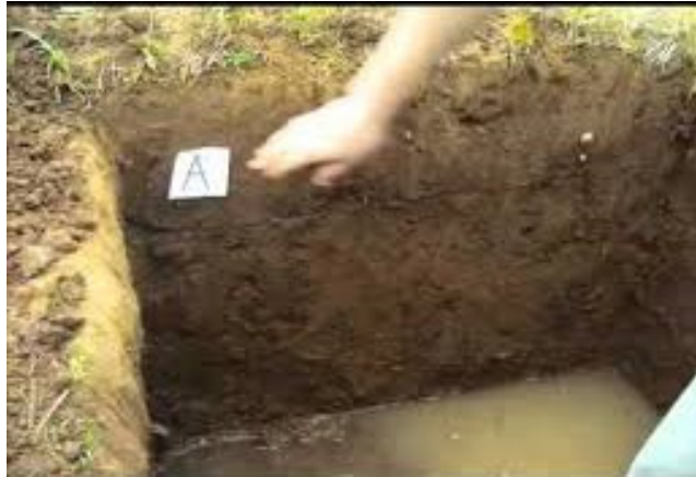
Figura No 1.3 Pozo a cielo abierto con nivel freático superficial
