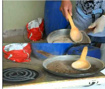
Figura No 1.44: Ensayo de Estado (Humedad)
