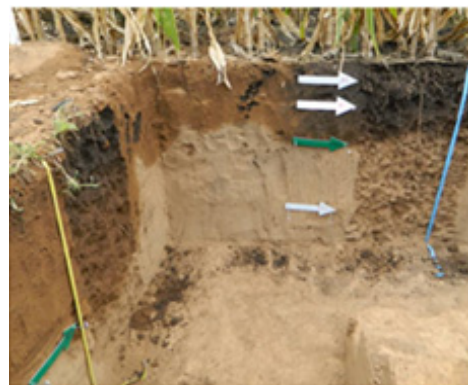
Figura No 1.2: Pozo a cielo abierto
