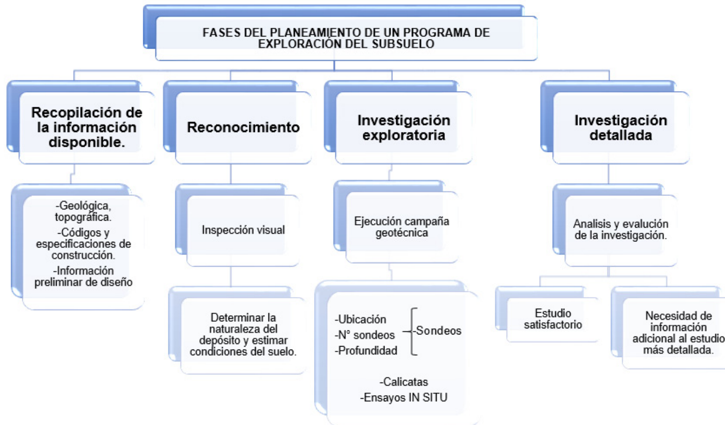
Figura No 8.5: Esquema de fases del programa de exploración del subsuelo
