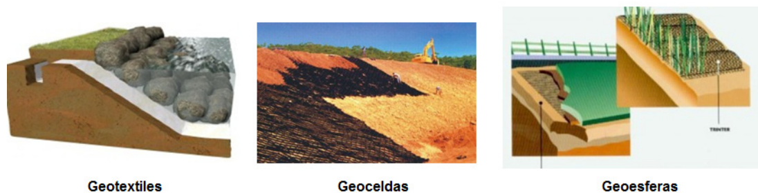
Figura No 6.48: Uso de Geotextiles
