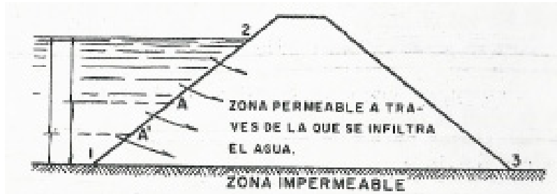
Figura No 3.7: Condiciones de frontera de la red de flujo en una presa de tierra
