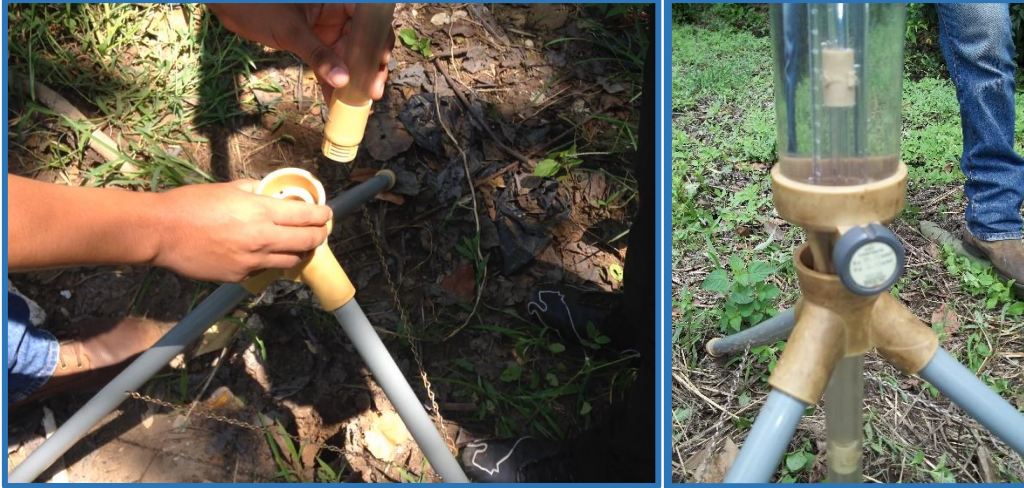
Colocación del permeatro en el tripode.
