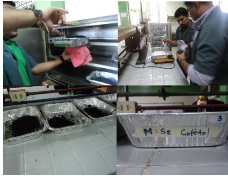
Fig. 7: Retiro de las muestras de la estufa y pesado de cada una después de secado.
