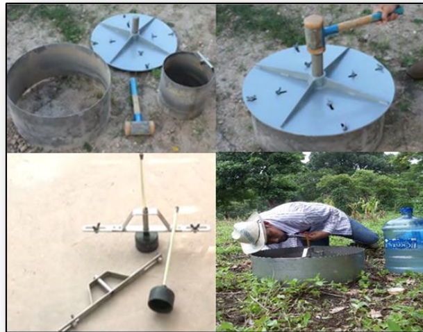
Fig. 2: Instalación de los cilindros infiltrómetros.
