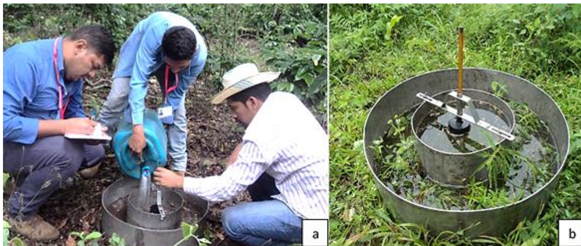
Figura 10 a y b. Pruebas de infiltración, método del infiltrómetro de doble anillo, Cantón La Morita, San Jorge, San Miguel, El Salvador, 2015
