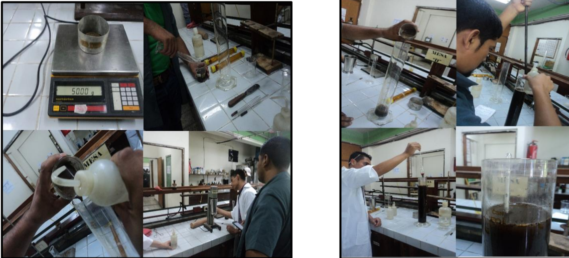
Fig.8 y 9: Análisis de muestras en laboratorio de suelos mediante el método de bouyoucos.
