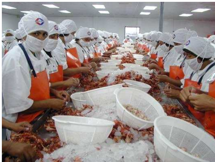
FIGURA 28: Proceso de descolado (extracción del exoesqueleto) y desvenado (Extracción del tracto gastrointestinal)
