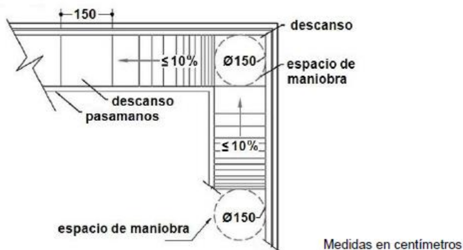
Figura 25 Vista en planta esquemática de una rampa de dos ramas perpendiculares, donde se grafican los espacios de maniobra en descansos y en el sector inmediato al comienzo. Recuperado de (CONAIPD, 2014)
