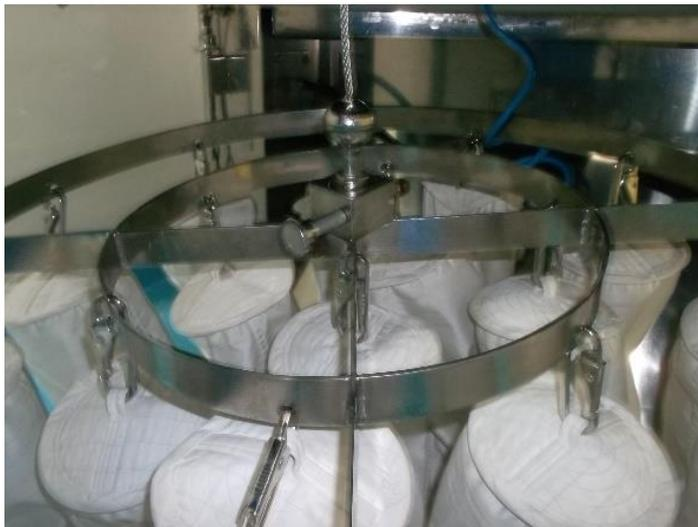
Figura N°8. Mangas de nylon sintético del Secador de Lecho Fluido. YENCHEN Modelo YC-SEP-FBD-60.
