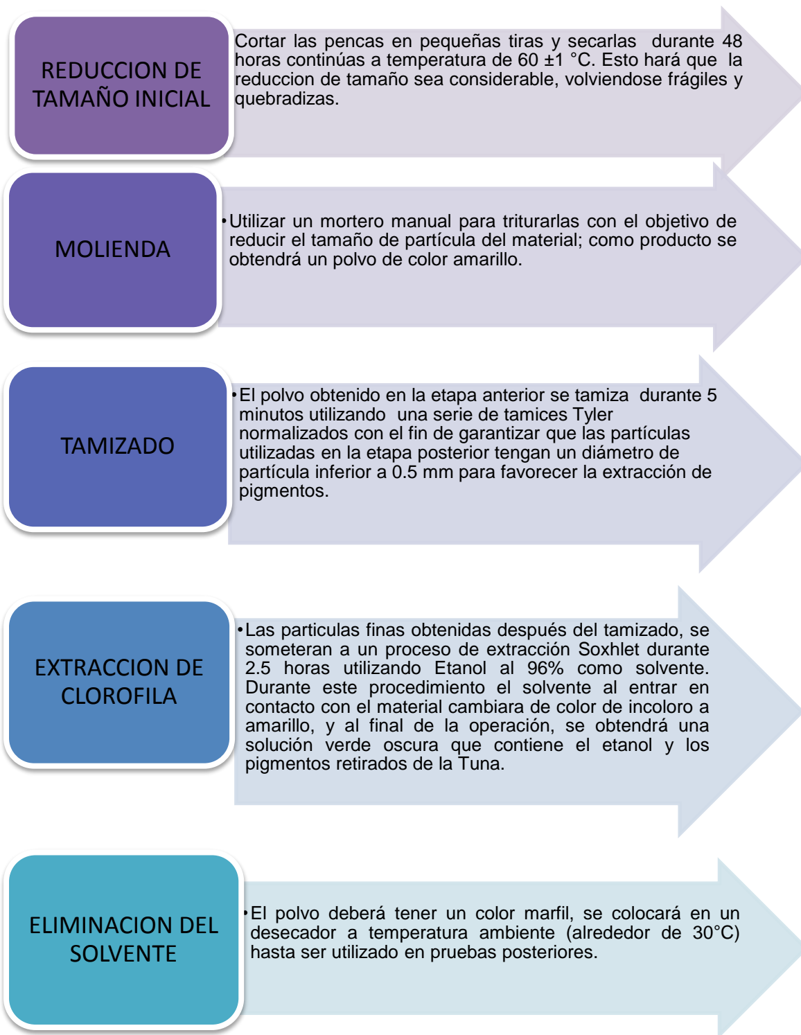
Figura 2.2 Diagrama de extracción del nopal ( Opuntia ficus indica ).
