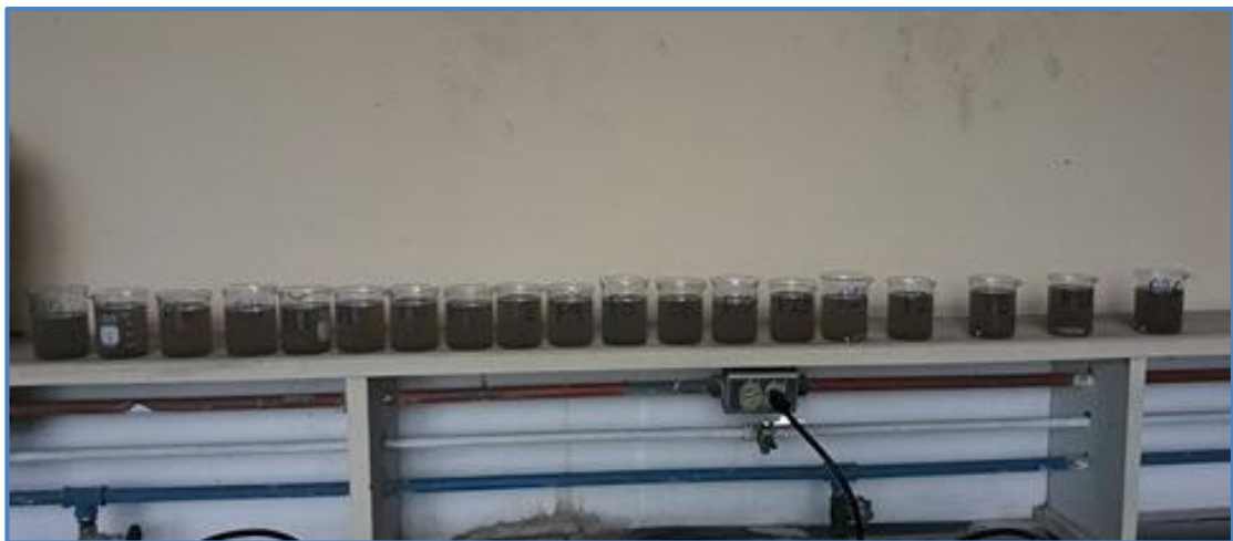
Figura 4.13 Pruebas realizadas en el diseño de experimento utilizando floculante a partir de nopal ( Opuntia ficus indica ).
