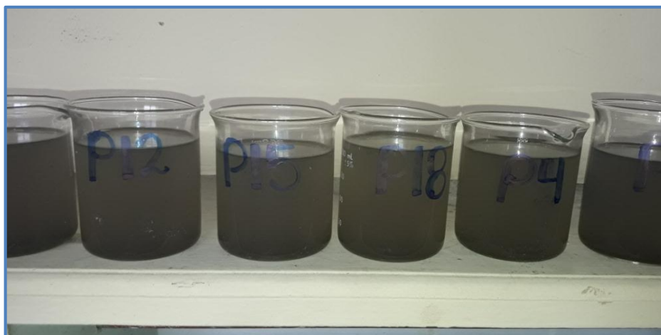
Figura 3.5 Fotografía de las pruebas realizadas con el floculante del cladodio del nopal ( Opuntia ficus-indica ).
