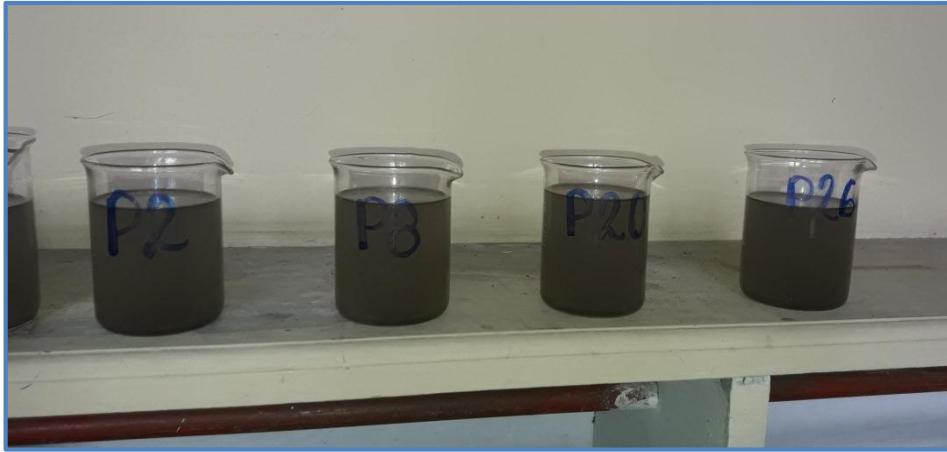
Figura 3.6 Pruebas con el floculante del nopal ( Opuntia ficus indica ).
