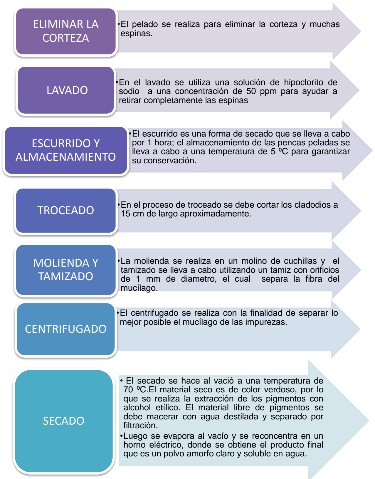
Figura 2.4 Diagrama de extracción del nopal ( Opuntia ficus indica ).
