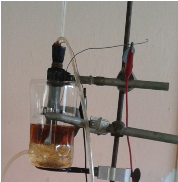
Figura 27: Iniciando el tratamiento con el reactor electroquímico a los 5 minutos aproximadamente.
