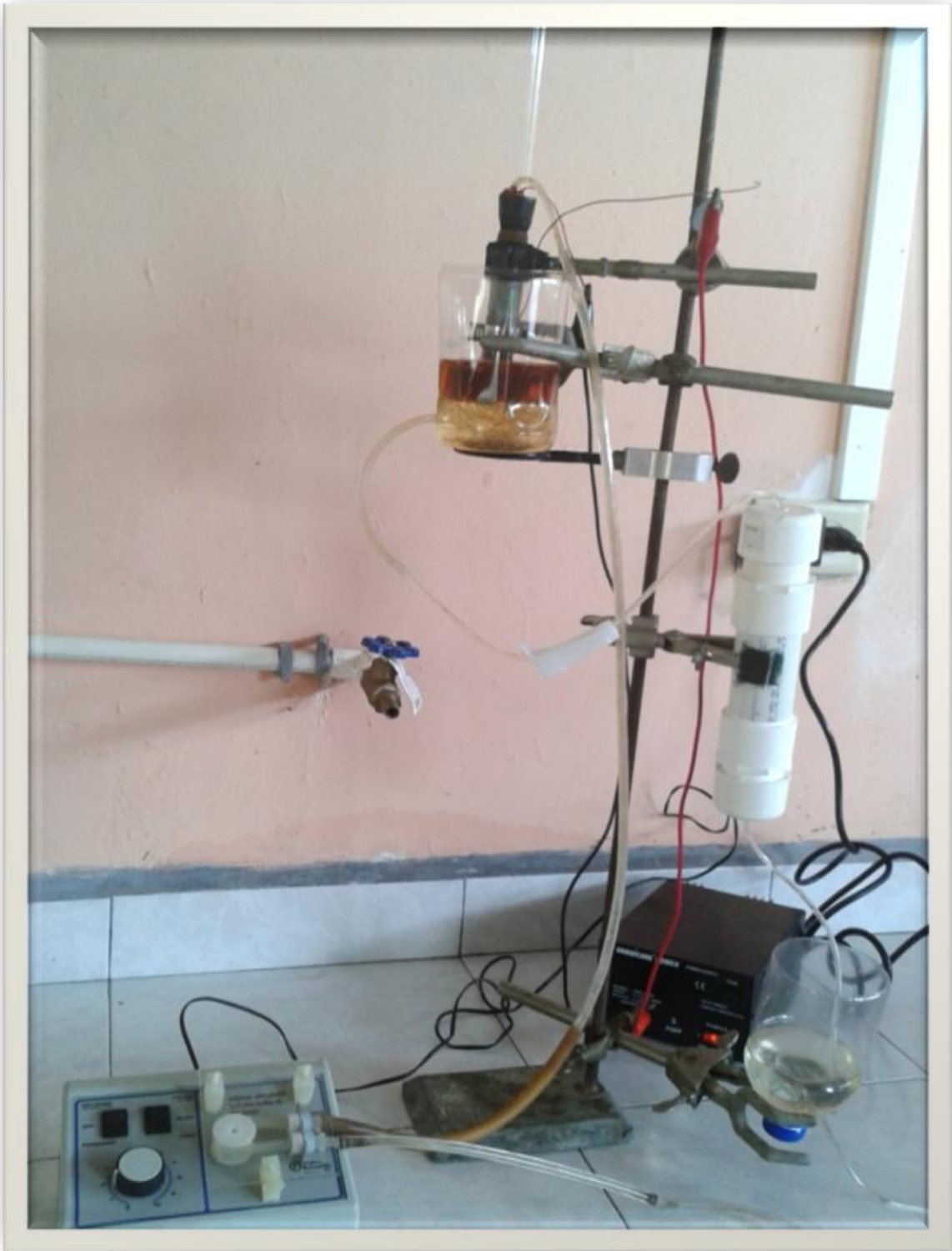
Foto 4: Reactor electroquímico con el aceite mineral.
