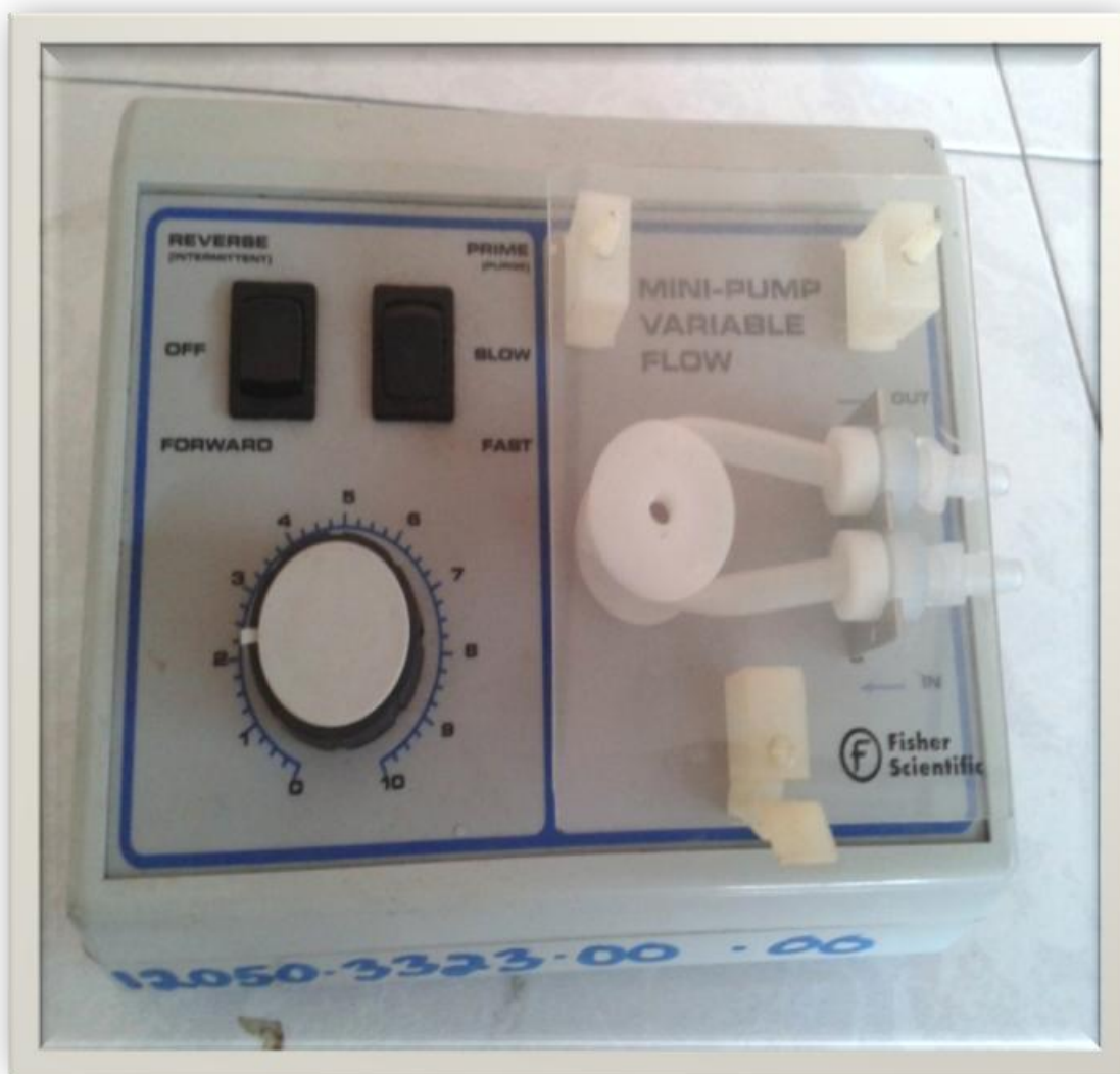
Foto 1: Bomba peristáltica para el flujo del electrolito ( \text{Na}_2\text{SO}_4 al 3%).
