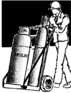
**Figura 3.17** Transporte de cilindros. (NEO-05)
