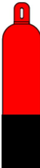
**Figura 3.12** Código de colores para tanques de metano. (NEO-05)
