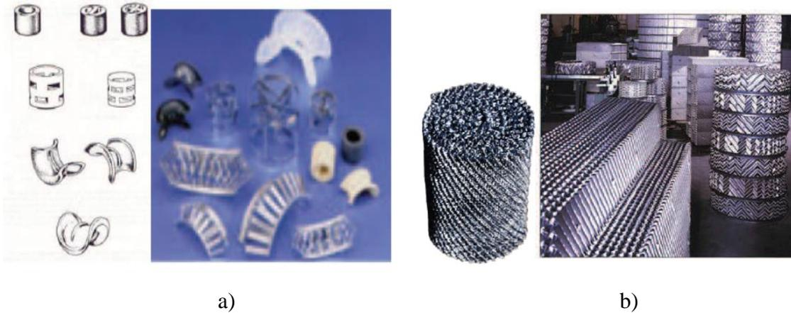
**Figura 2.7** a) Empaques al azar. b) Empaques estructurados. (Valiente, 2010)
