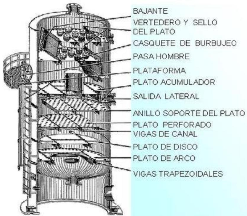
**Figura 2.9** Columna de absorción con platos. (Valiente, 2010)
