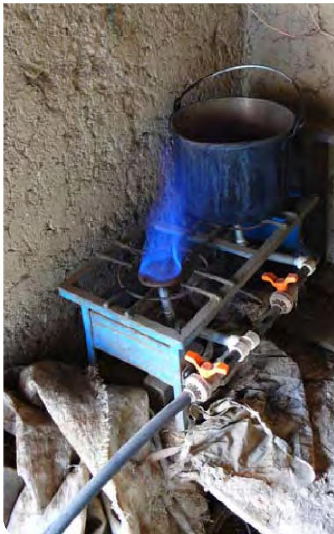
*Figura A37.2: Cocina artesanal de biogás hecha con tubería de hierro y estructura de barro. Fuente: Herrero, 2008.*
