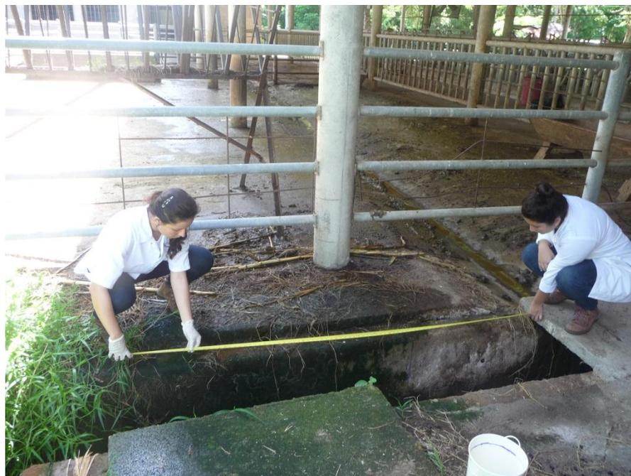
*Figura A4.1: Medición de canaleta de descarga*
