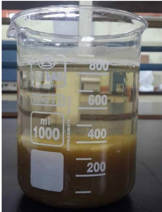
Figura A17.4: Resultado de tratamiento fisicoquímico a dosis optima y pH óptimo para caracterización.
