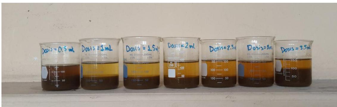
Figura A13.2: Resultado con Sulfato de Aluminio determinando dosis óptima
