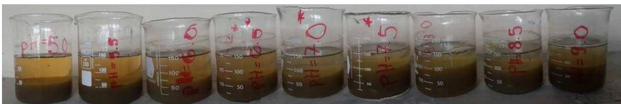
Figura A17.1: Resultados en determinación de pH con Policloruro de Aluminio (PAC) para efluente posterior a tratamiento anaeróbico
