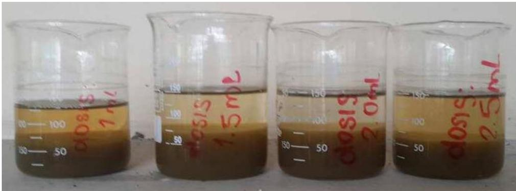
Figura A17. 3: Resultados de determinación de dosis óptima a pH de 7.5.
