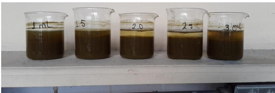
Figura A15. 2: Resultados con Policloruro de Aluminio (PAC) en determinación dosis óptima.
