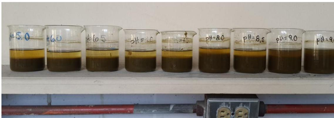
Figura A15.1: Resultados con Policloruro de Aluminio (PAC) en determinación de pH óptimo.
