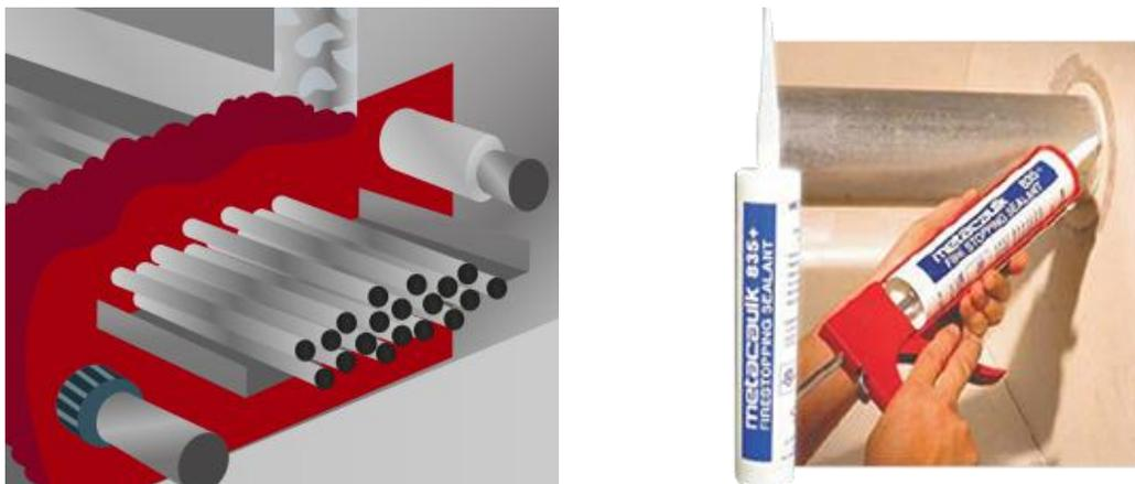
Figura A44.1: Colocación de Espuma en tubería. (HILTI, 2017)
