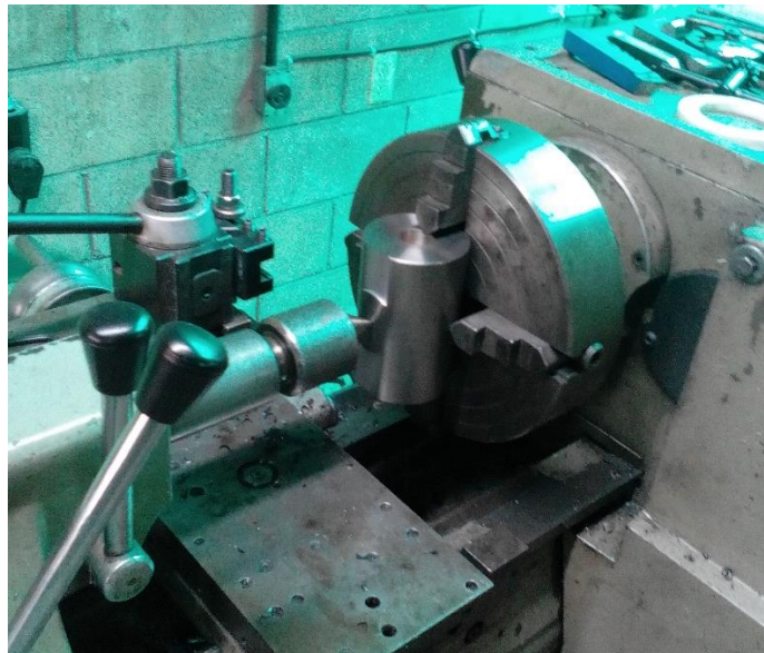
Fig. 3.6. Maquinado de superficie cilíndrica del cuerpo del empujador.
