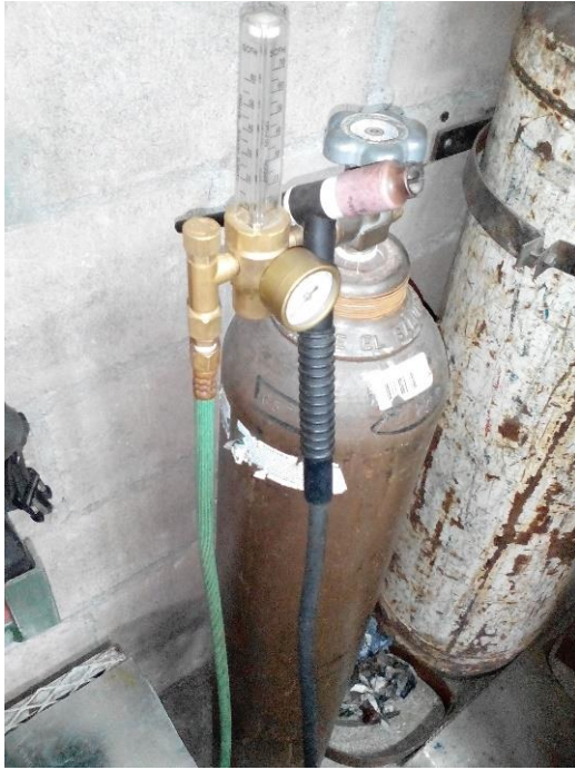
Fig. 3.12. Cilindro contenedor de argón, flujómetro y antorcha para soldadura TIG.
