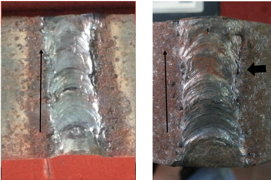
Fig. 4.23. Cordón de soldadura antes y después del ensayo doblado de cara.
