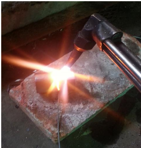
Fig. 3.16. Calentamiento por medio de una antorcha de autógena.
