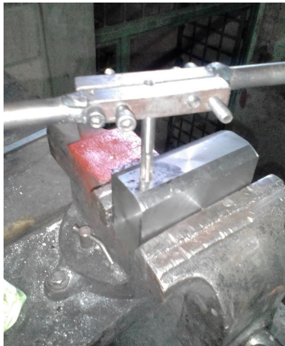
Fig. 3.8. Roscado en cuerpo del empujador.
