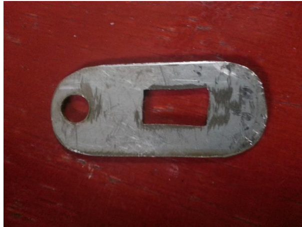
Fig. 3.14. Placa de sujeción entre cuerpo y cabeza de empujador.
