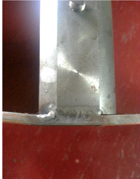
Fig.3.13. Unión soldada entre empujador y placa.
