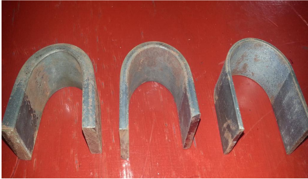
Fig. 4.22. Dobleces de prueba para espesores de 9.5mm, 6.35mm y 3.18mm.
