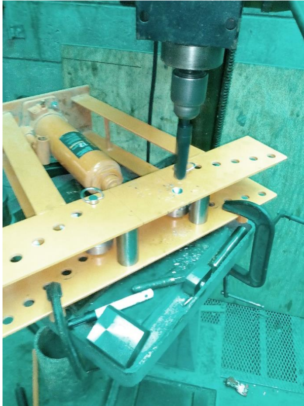
Fig. 3.11. Placas de prensa hidráulica siendo perforadas en taladro de banco
