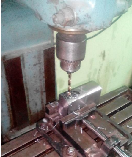
Fig. 3.7. Taladrado de agujeros pre roscado en el cuerpo del empujador.
