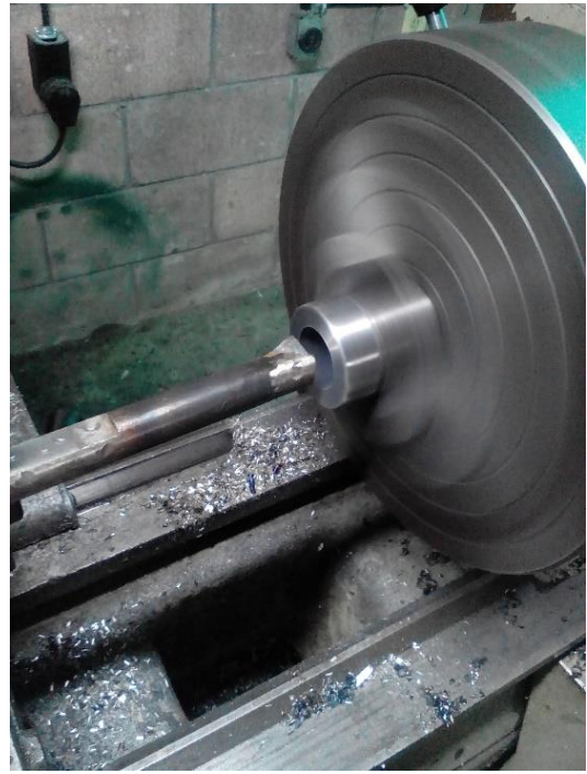
Fig. 3.4. Cilindrado interno de rodillo de apoyo.
