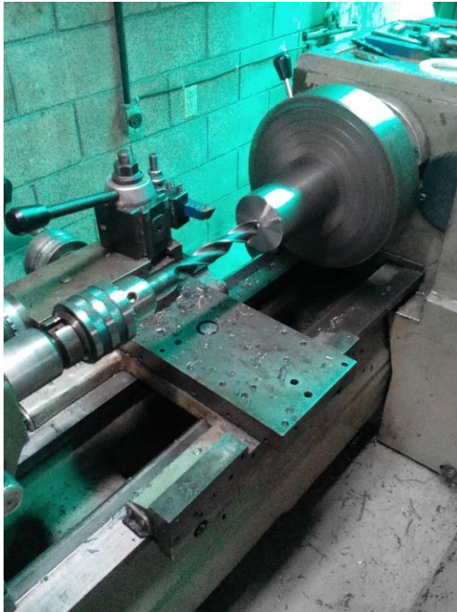
Fig. 3.5. Perforación de agujero en cara inferior de cuerpo del empujador.
