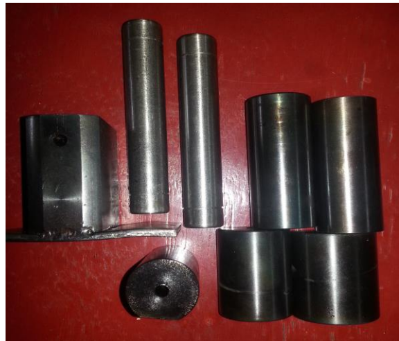
Fig. 3.17. Accesorios después de pavonado.
