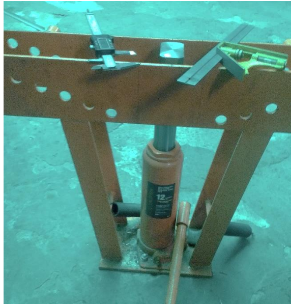
Fig. 3.10. Prensa hidráulica con sus placas a perforar.
