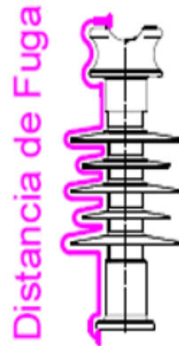
Fig. 25: Distancia de fuga de Aislador Polimérico ANSI 51-2C.
