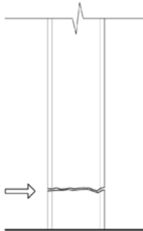
Ilustración 4. 3 Poste quebrado en posición original y sin armadura expuesta.
