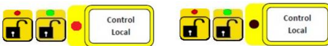
Ilustración 4. 23 Activación del control local / Desactivación del control local.
