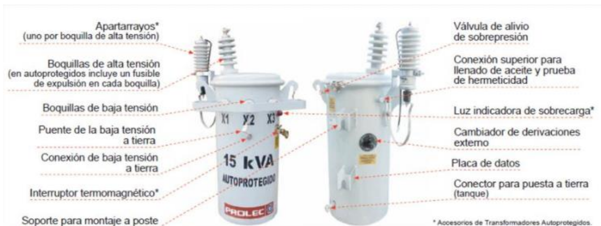
Ilustración 4. 17 Partes de un transformador.
