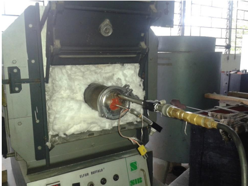
Fig. 2.9. Cámara de gas inerte durante el post tratamiento térmico de los discos cementados.
