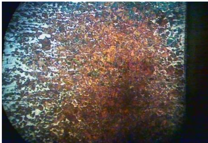
Fig. 3.2. Medición del espesor de la capa cementada.
