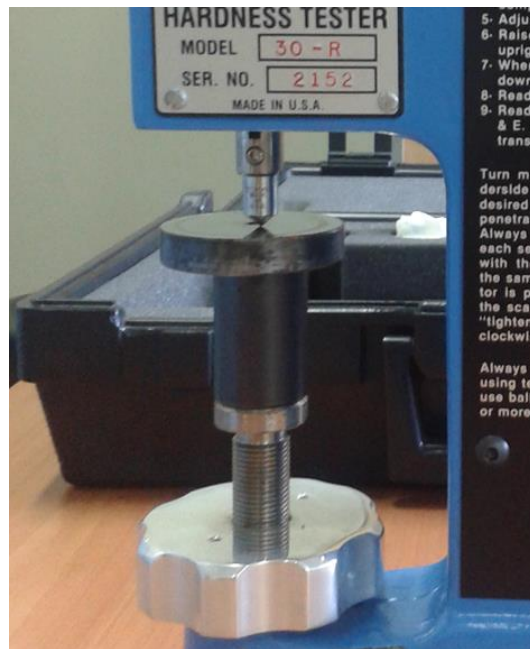
Fig. 2.18. Posicionamiento de la probeta durante la medición de dureza.
