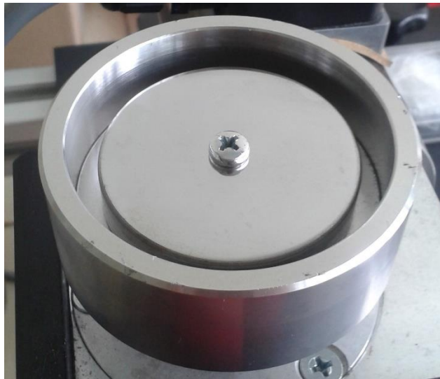
Fig. 2.11. Disco de acero AISI 1020 tras el proceso de lijado.
