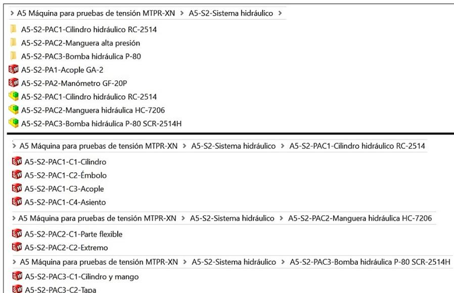
Fig. 3.23. Piezas del sistema hidráulico de la máquina MTPR-XN.
