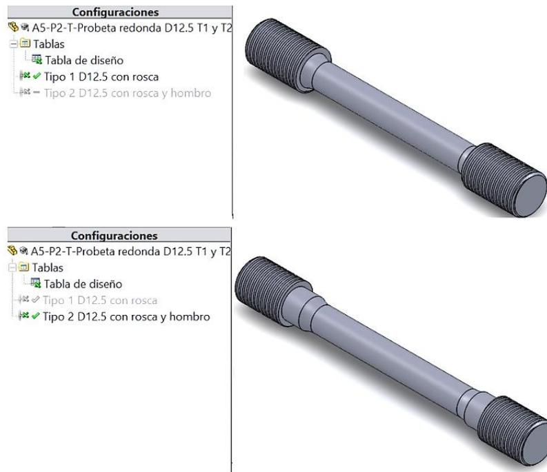
Fig. 3.32. Configuraciones para las probetas con extremo roscado (tipo 1 y tipo 2) de la máquina MTPR-XN.
