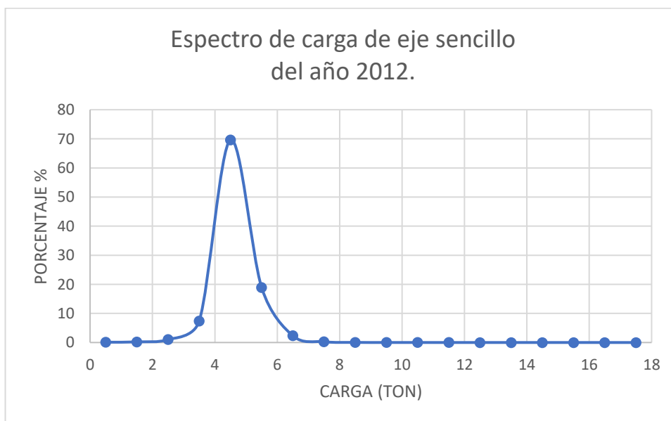
Figura 4.5.1.1 Espectro de carga de eje sencillo direccional 2012.
