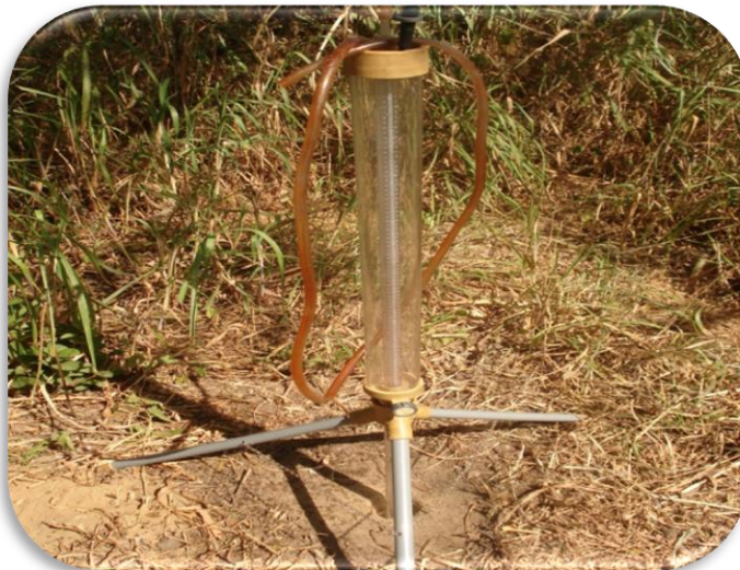
Figura 3. Realizando pruebas de infiltración con el Permeámetro de Guelph
