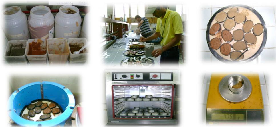
Figura. 9. De izquierda a derecha: muestras de suelo saturado, colocación de suelo en los hules, colocar el plato de cerámica en las ollas de presión, colocar las muestras en una estufa y pesado.
