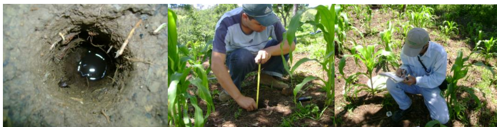
Figura. 7. Toma de datos con el método de Porchet, para la infiltración básica en las distintas formaciones geológicas, San Fernando, Chalatenango.
