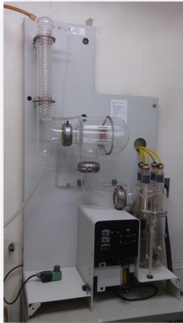
Anexo 3. Destilador utilizado en el Laboratorio de Control de Calidad de la Unidad de Aseguramiento de la Calidad del laboratorio Dr. Max Bloch.
