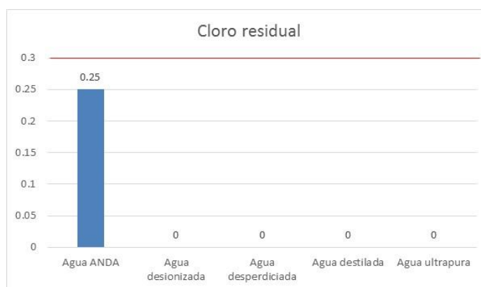
Figura 10. Cloro residual de las aguas producidas por el sistema purificador sin reestructurar.
