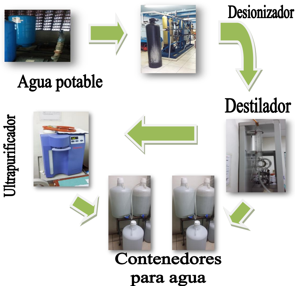
Figura 5. Componentes del sistema purificador de agua del laboratorio de Control de Calidad del MINSAL.
