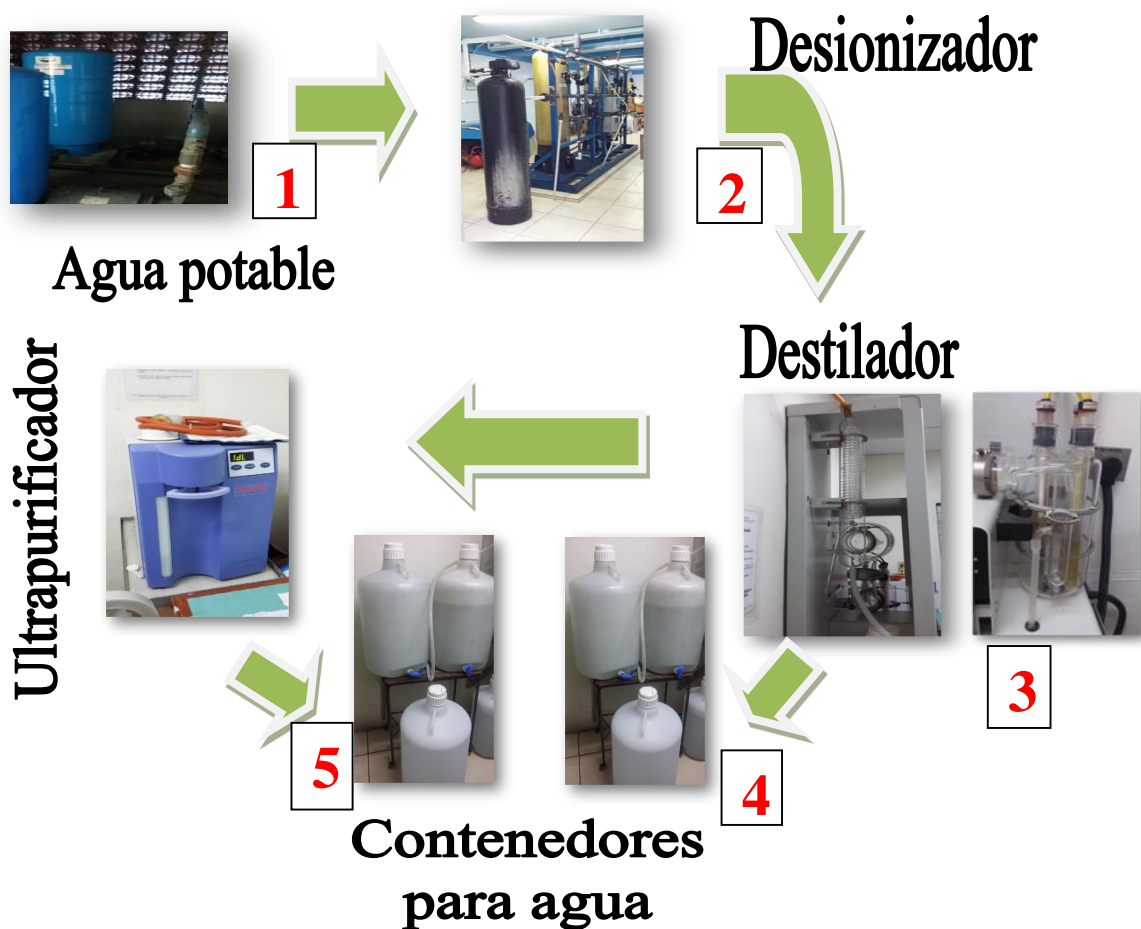
Figura 7. Puntos de muestreo en el sistema purificador de agua sin reestructurar del MINSAL.
