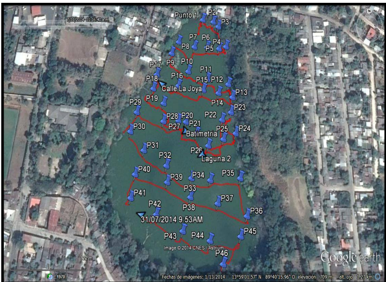
Figura 3.12 Recorrido en lancha realizado para la obtención de coordenadas geodésicas y profundidades de cada punto.
