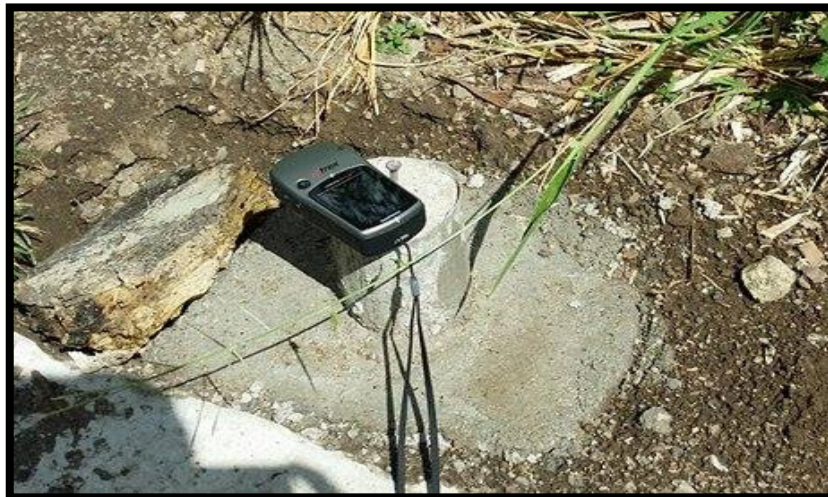
Figura 3.10: Obtención de Coordenadas y elevación de Banco de Marca en laguna Cuscachapa
