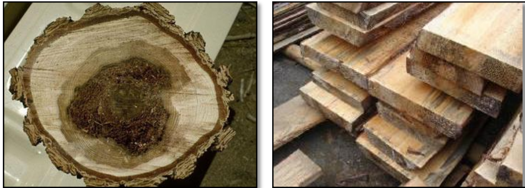
Figura 3.16. a) Tronco con pudrición avanzada; b) tablas de pino manchadas con hongo generador de pudrición
