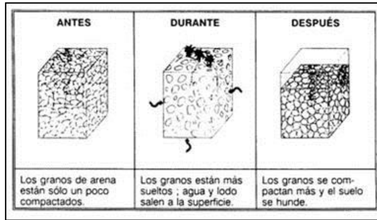
Figura 3.28 Esquema de una masa de suelo con el fenómeno de licuación.
