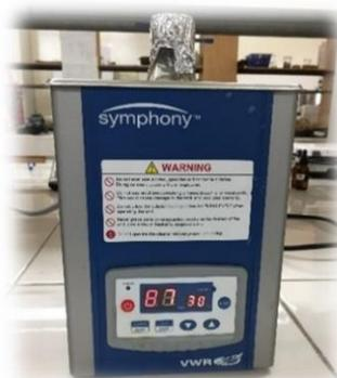
Figura N° 40. Baño ultrasónico, aparato utilizado para realizar la maceración ultrasónica.
