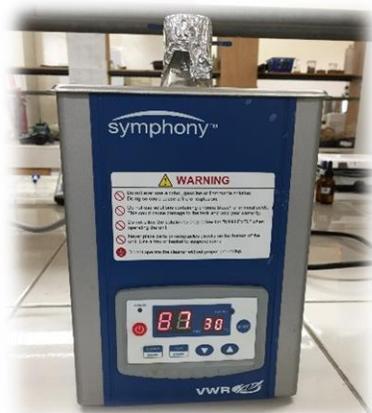
Figura N° 21. Baño ultrasónico, aparato utilizado para realizar la maceración ultrasónica.
