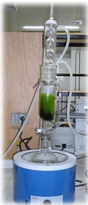
Figura N° 23. Aparato Soxhlet.
