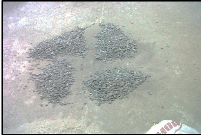
Cuarteo de agregado
