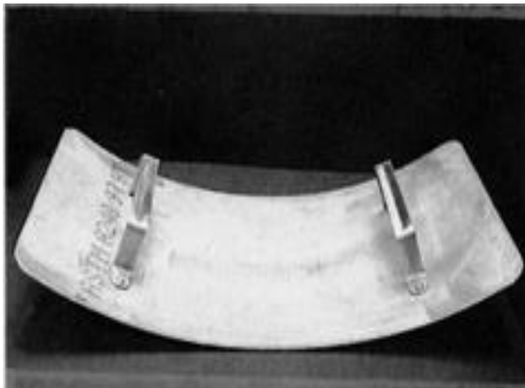
FIGURA # 3. 2 Compactador para ensayo de barrido.
