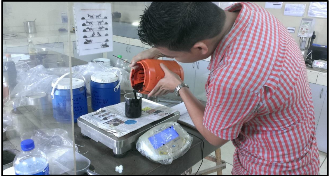
Peso de emulsión para colocación en papel asfalto.
