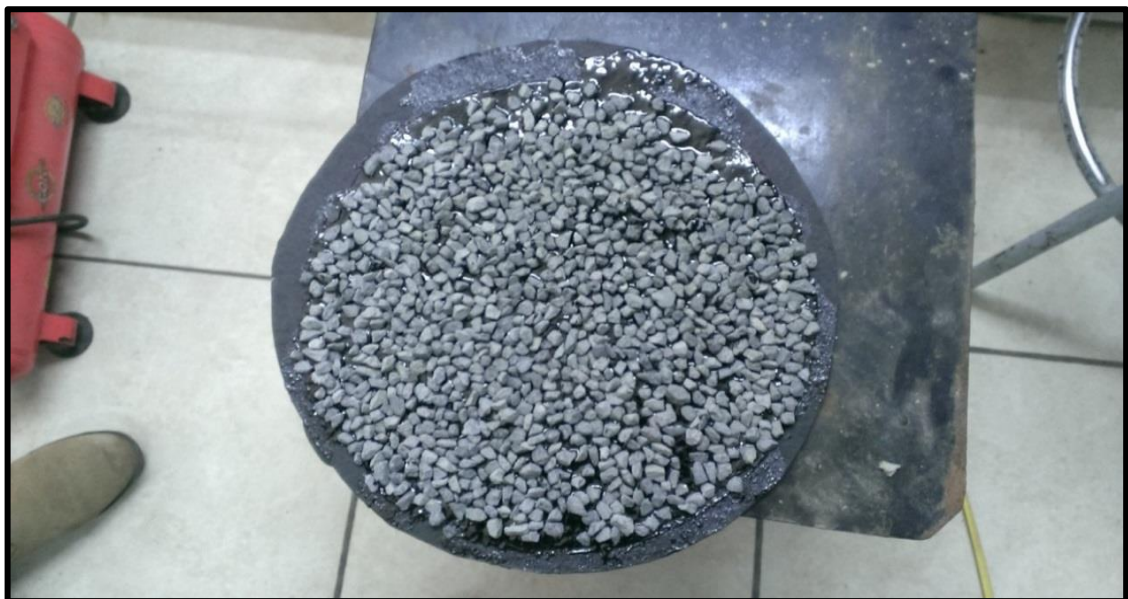
Colocación de emulsión sobre papel asfalto y agregado sobre emulsión.
