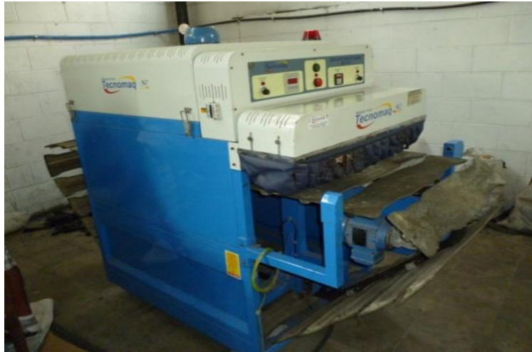
Figura núm. 21 Secador Reativador (1) Marca: Tecno-Maq Modelo: MT131, Serie 2005, capacidad: 1par /min, Numero 50905
