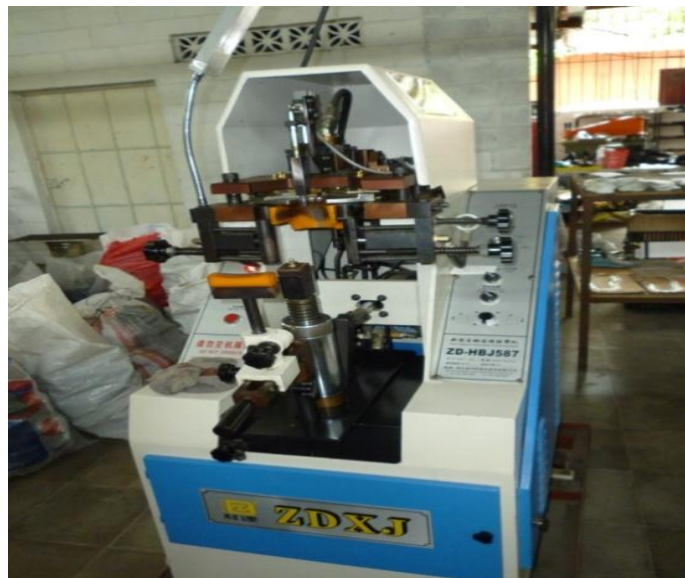
Figura núm. 22 Pegadora de suela, Marca: Zhuda Da Precision Machinery Co Ltd.
