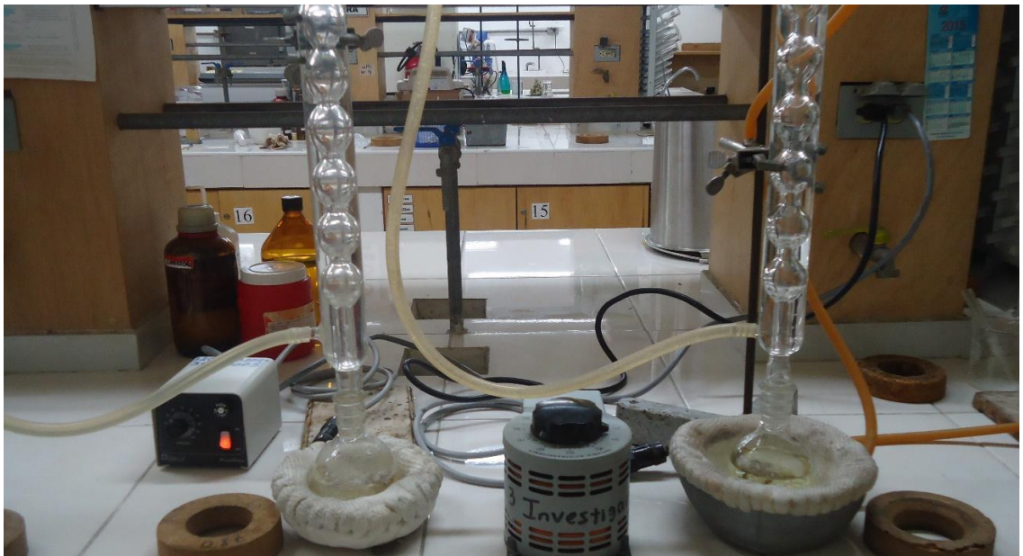
Figura. N°34. Aparato de obtención de extractos de muestras y estándares por el método de reflujo.
